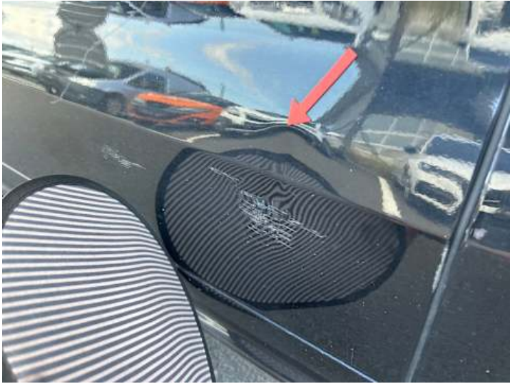
Türe hinten rechts (Kratzer, Verformung)
