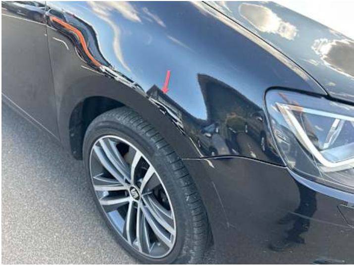
Kotflügel vorne rechts (Verformung)
