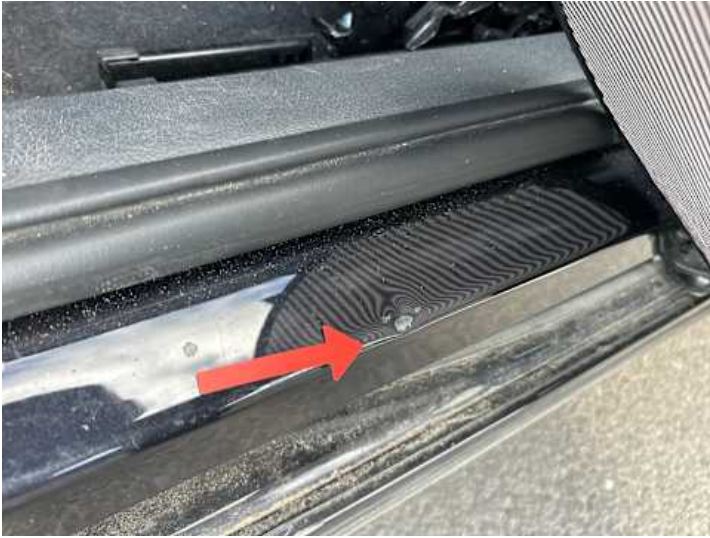
Schweller links (Delle, Kratzer)
