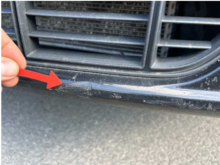
Stoßstange vorne (Kratzer, Verformung)
