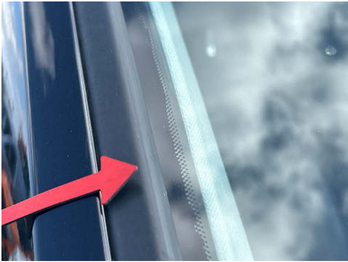
Windschutzscheibe (Anderer Schaden): Unsachgemäß Instandgesetzt
