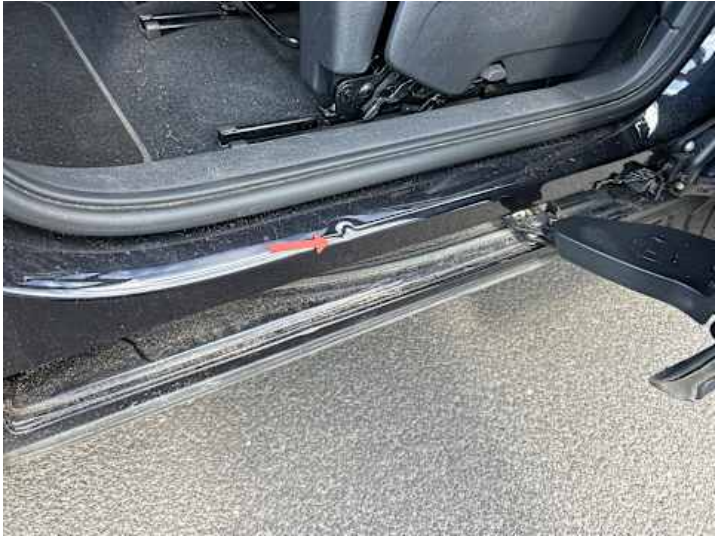
Schweller links (Delle, Kratzer)
