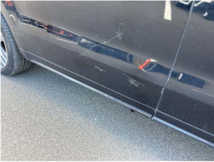
Türe hinten rechts (Kratzer, Verformung)
