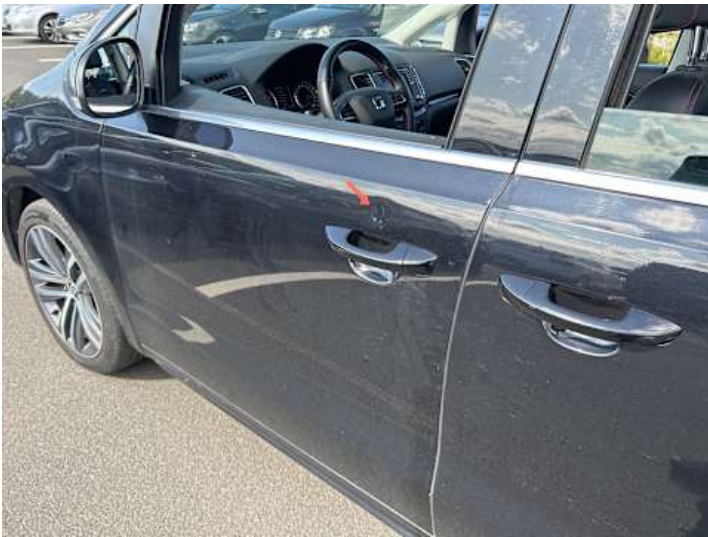
Fahrtür (Kratzer, Delle)
