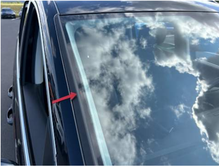
Windschutzscheibe (Anderer Schaden): Unsachgemäß Instandgesetzt
