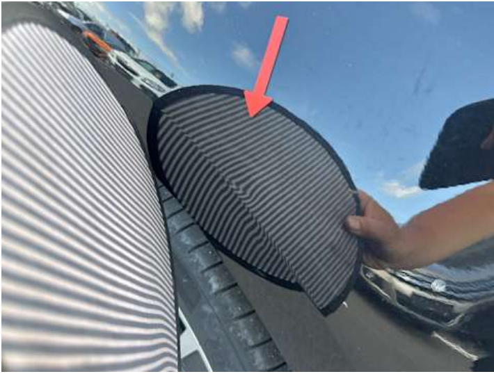
Kotflügel vorne rechts (Verformung)
