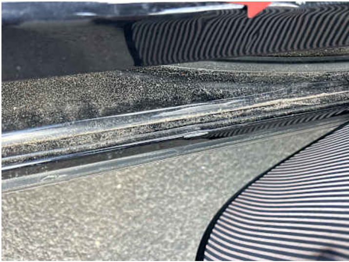
Schweller links (Delle, Kratzer)
