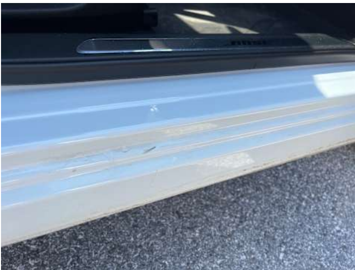
Schweller rechts (Kratzer)
