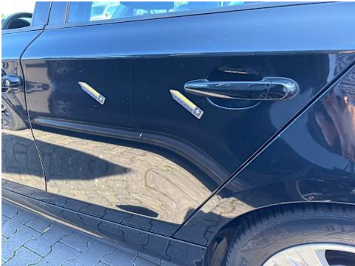
Türe hinten links (Kratzer, Lackschaden)
