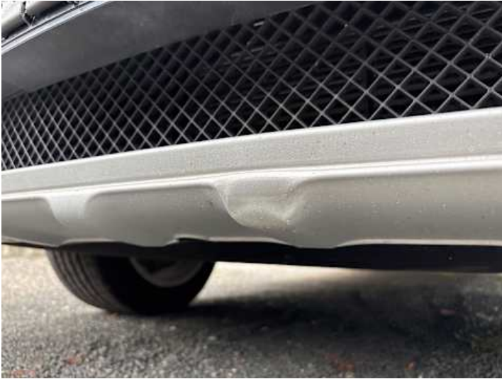
Stoßstange vorne (Verformung)
