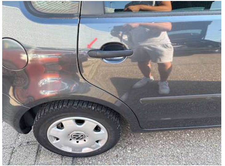
Türe hinten rechts (Verformung)
