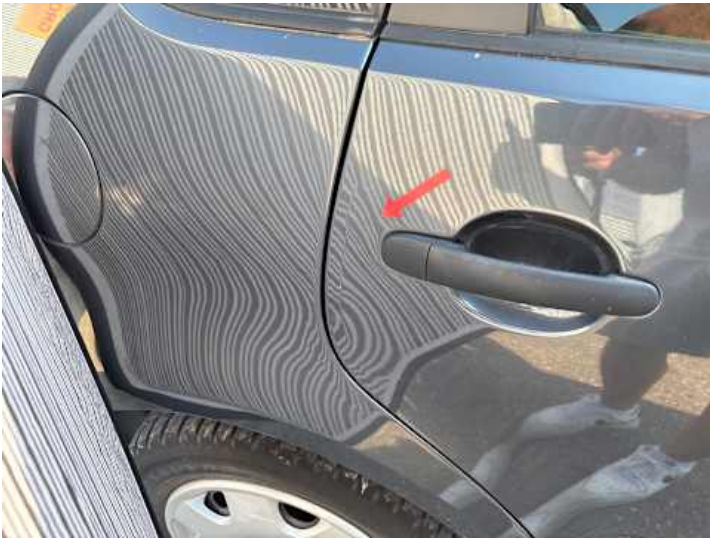
Türe hinten rechts (Verformung)
