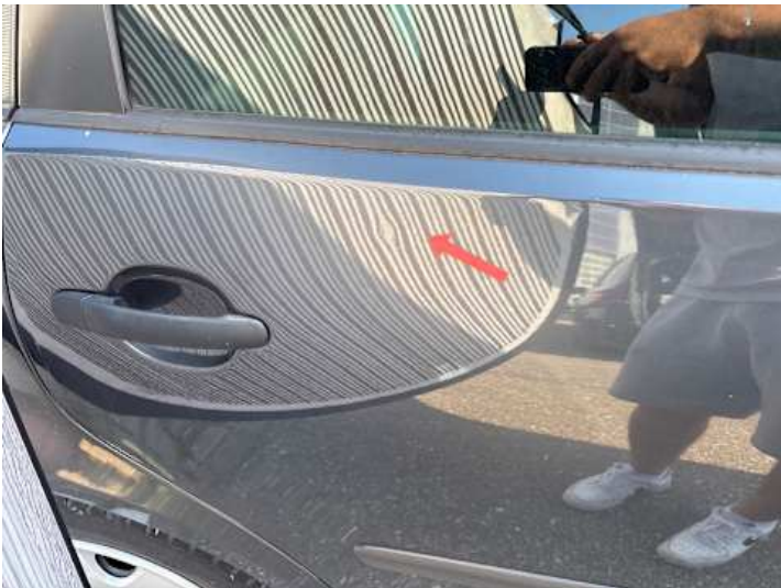
Türe hinten rechts (Delle)
