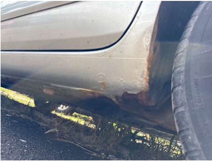
Schweller links (Rost)
