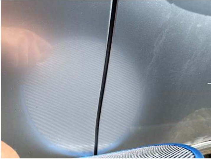
Türe hinten rechts (Delle)
