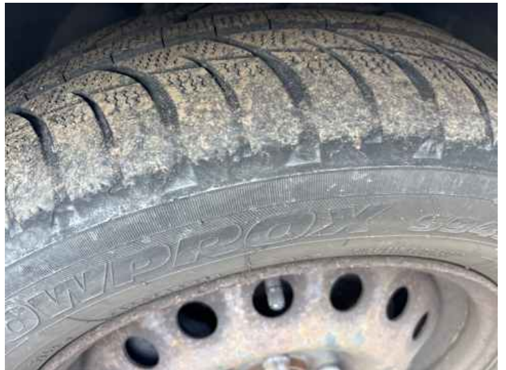
Rad (Ungleichmäßig abgefahren)
