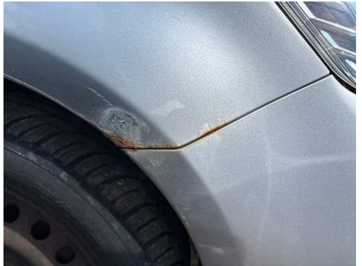
Kotflügel vorne rechts (Rost, Lackschaden)
