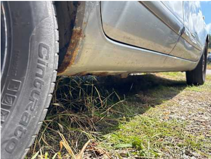
Schweller rechts (Rost)
