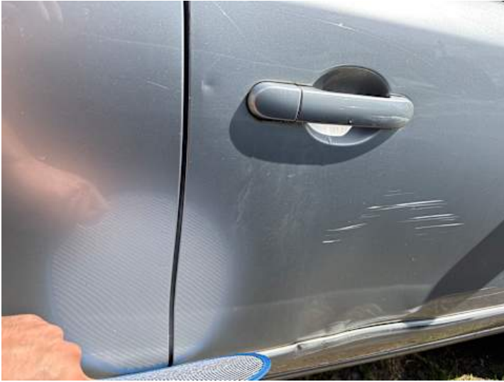
Türe hinten rechts (Delle)
