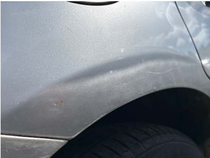
Seitenteil hinten rechts (Kratzer)
