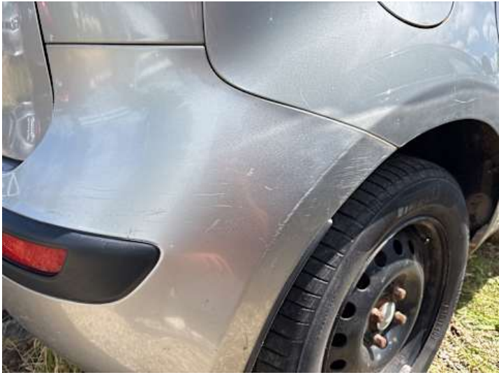
Stoßstange hinten (Kratzer, Spaltmaße ungenau)
