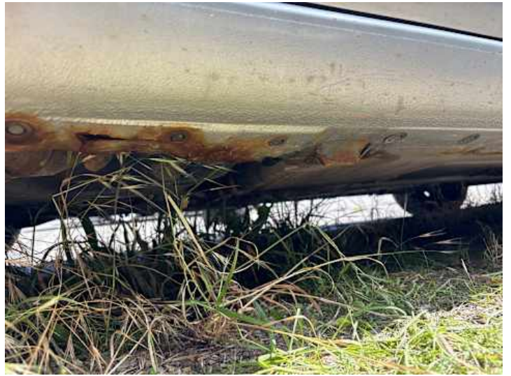
Schweller rechts (Rost)
