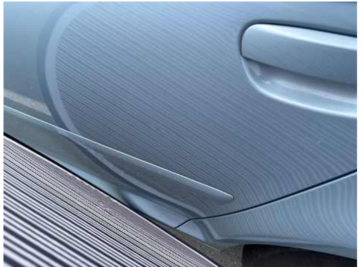
Türe hinten links (Delle)
