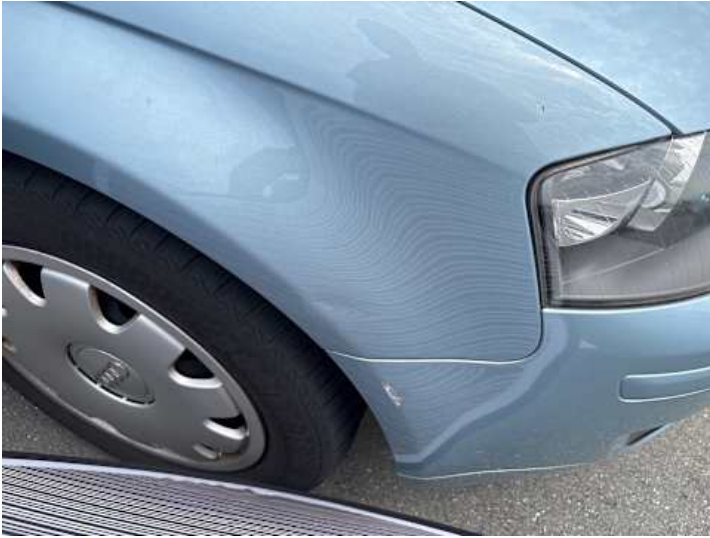
Kotflügel vorne rechts (Delle)
