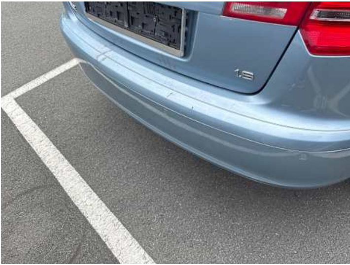
Stoßstange hinten (Kratzer)
