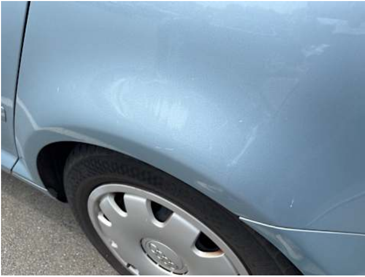
Seitenteil hinten links (Kratzer)
