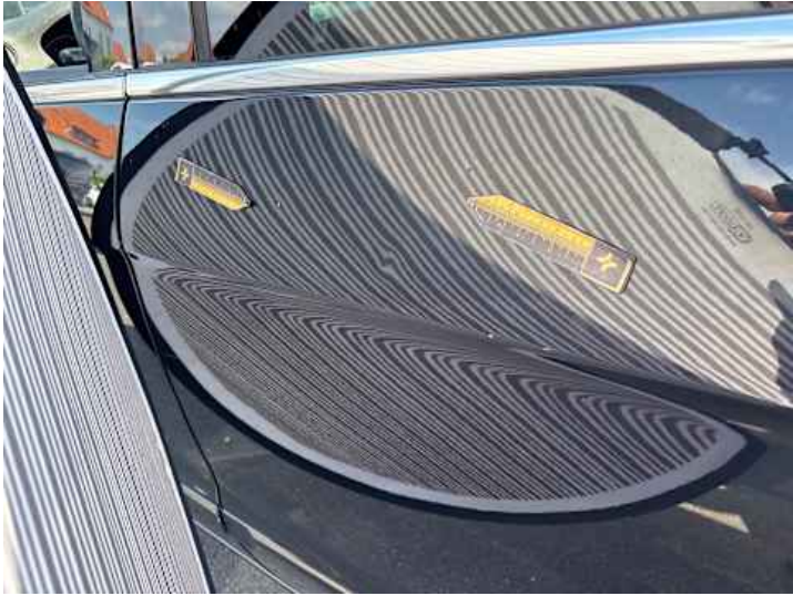
Türe hinten links (Delle)
