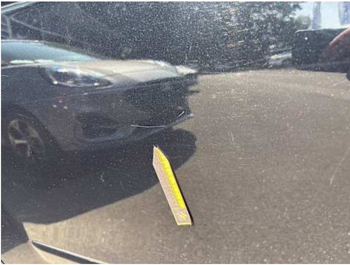
Türe hinten rechts (Kratzer)
