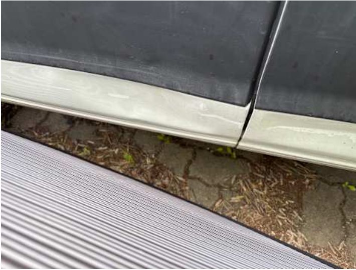
Seitenteil hinten rechts (Unsachgemäß instand gesetzt, Verformung, Kratzer)
