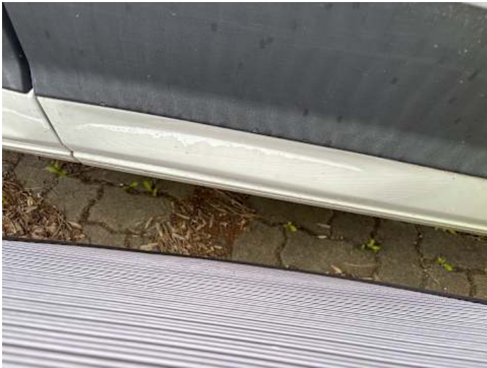
Türe hinten rechts (Unsachgemäß instand gesetzt, Verformung, Kratzer)
