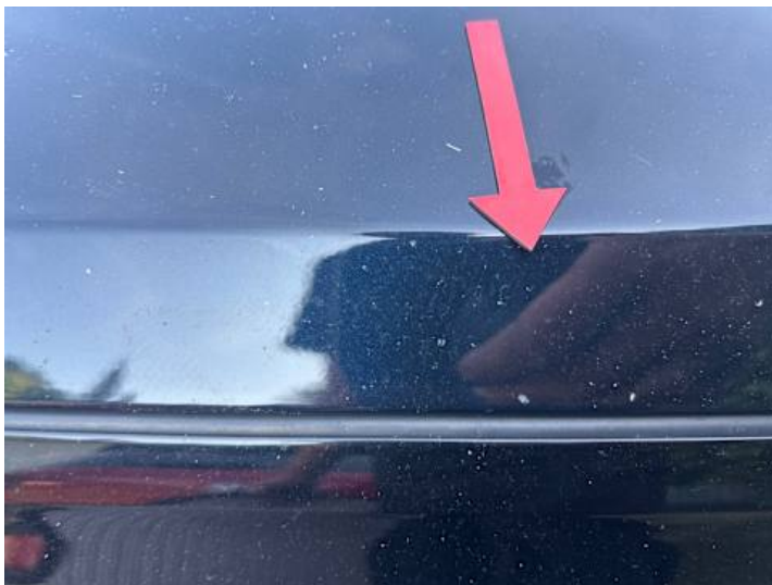
Motorhaube (Lackschaden, Steinschlag)
