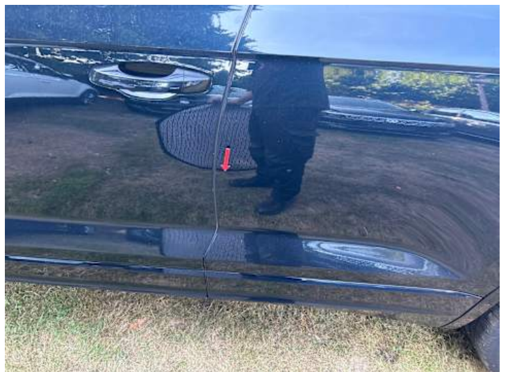
Türe hinten links (Kratzer, Lackschaden)
