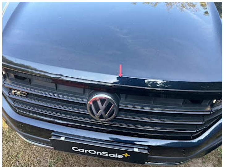
Motorhaube (Lackschaden, Steinschlag)
