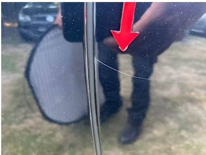
Türe hinten links (Kratzer, Lackschaden)
