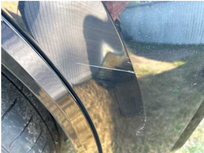
Stoßstange vorne (Lackschaden)
