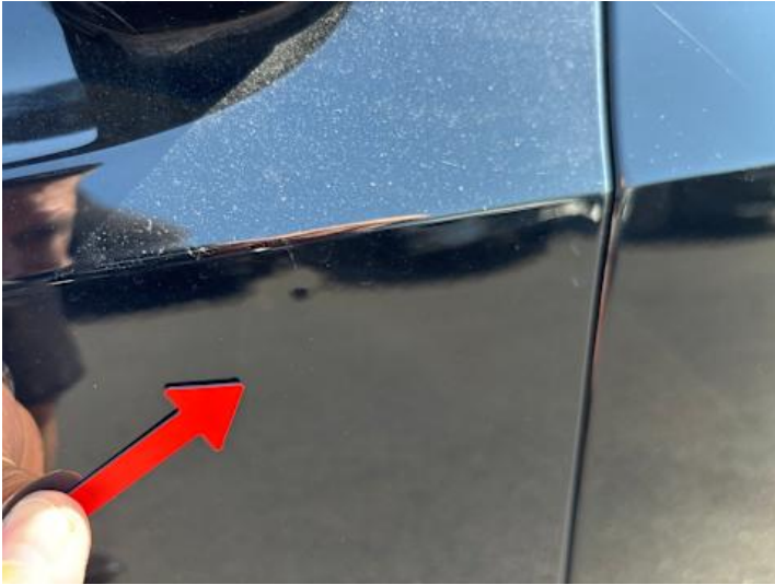
Fahrtür (Delle, Kratzer)
