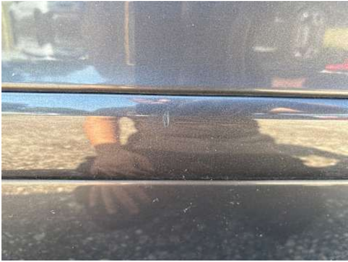
Türe hinten rechts (Kratzer, Lackschaden)
