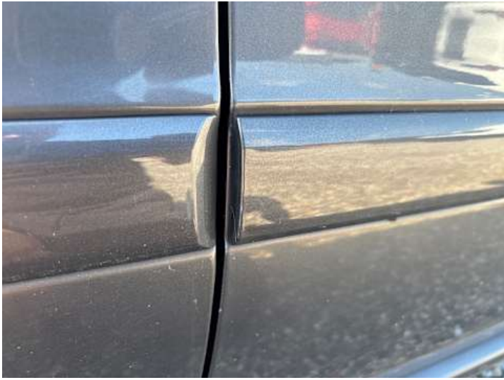
Beifahrtür (Kratzer, Lackschaden)
