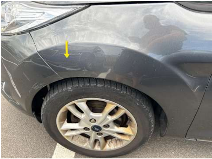
Kotflügel vorne links (Kratzer, Verformung)
