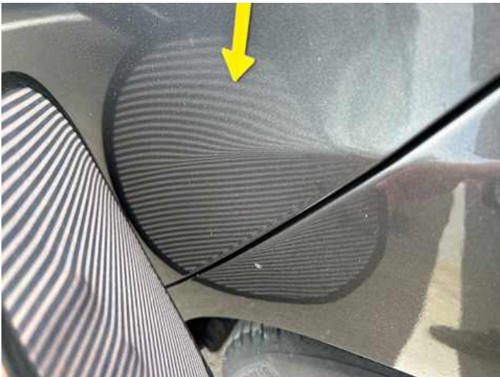
Türe hinten links (Unsachgemäß instand gesetzt)
