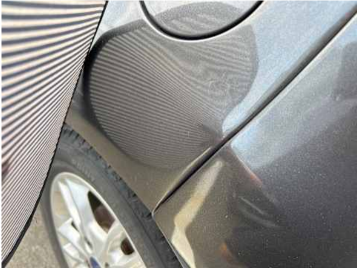
Seitenteil hinten links (Unsachgemäß instand gesetzt, Verformung)
