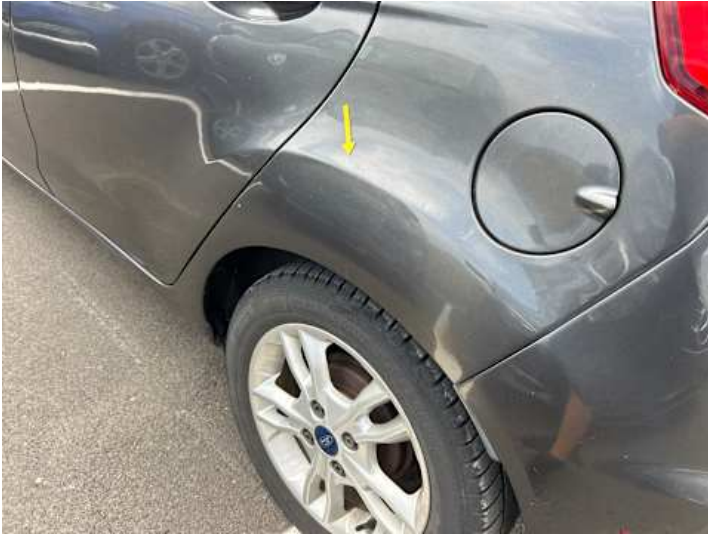
Seitenteil hinten links (Unsachgemäß instand gesetzt, Verformung)
