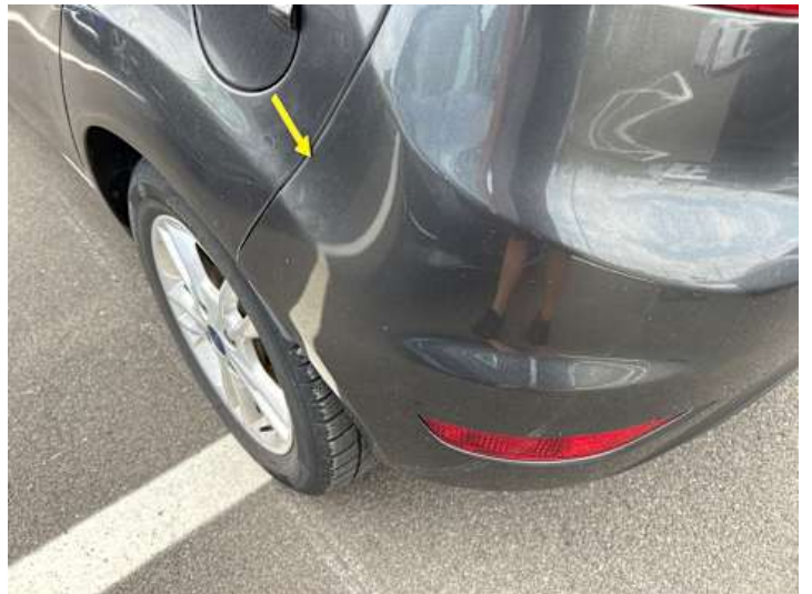
Stoßstange hinten (Unsachgemäß instand gesetzt)
