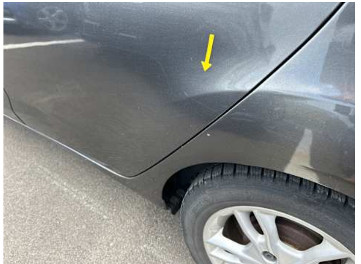
Türe hinten links (Unsachgemäß instand gesetzt)
