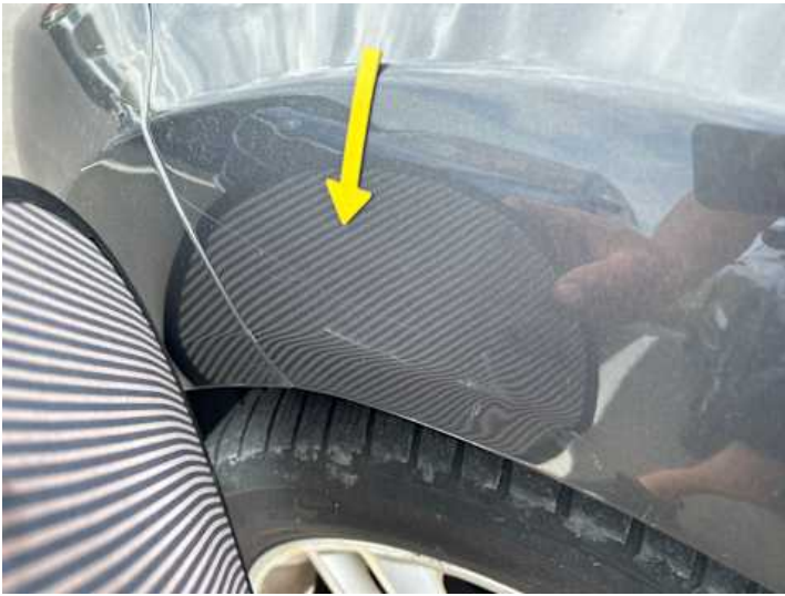
Kotflügel vorne links (Kratzer, Verformung)
