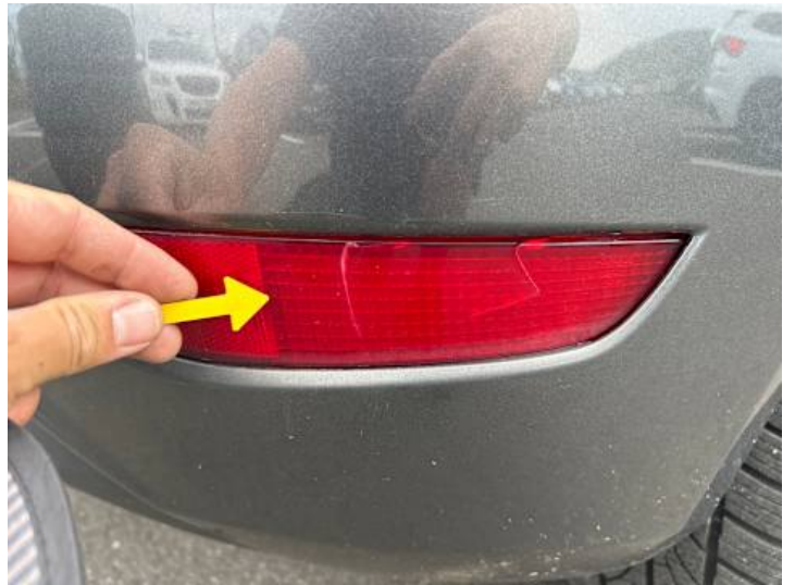
Stoßstange hinten (Riss/Bruch)
