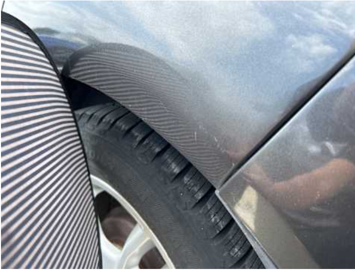
Seitenteil hinten links (Unsachgemäß instand gesetzt, Verformung)
