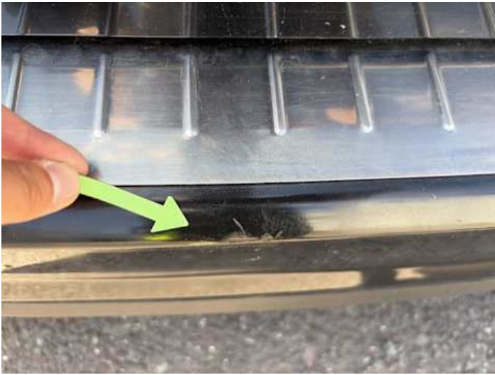
Stoßstange hinten (Verformung)
