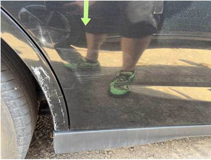
Türe hinten rechts (Kratzer)
