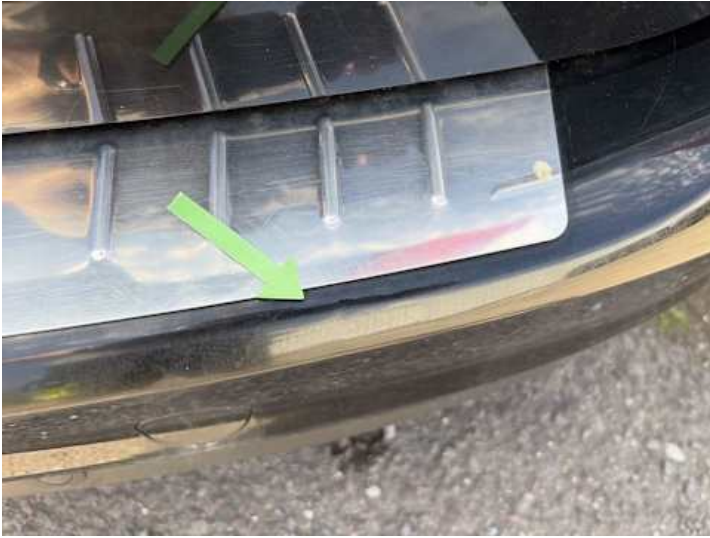
Stoßstange hinten (Verformung)
