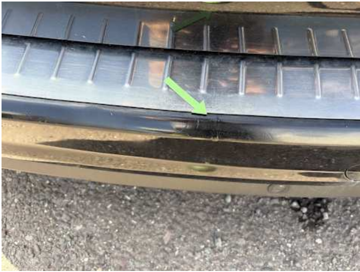
Stoßstange hinten (Verformung)
