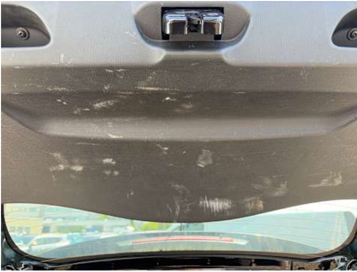
Heckklappe (Kratzer, Anderer Schaden): Verschmutzung
