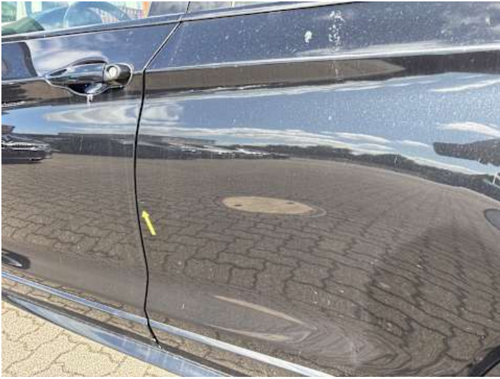
Türe hinten links (Kratzer, Delle)
