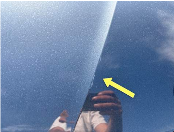
Motorhaube (Kratzer, Lackschaden)
