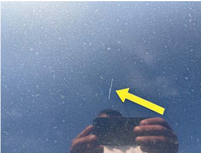
Motorhaube (Kratzer, Lackschaden)
