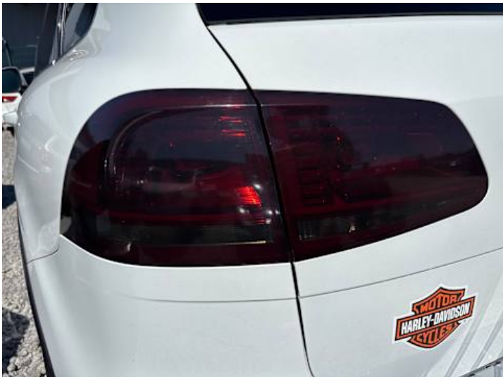
Rücklicht (links) (Anderer Schaden): Foliert
