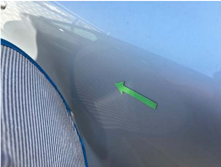
Türe hinten rechts (Delle)
