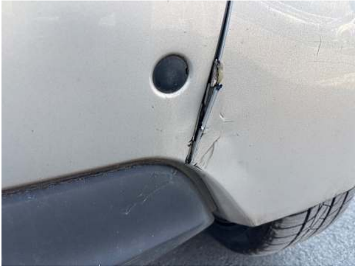
Seitenteil hinten rechts (Kratzer, Riss/Bruch)
