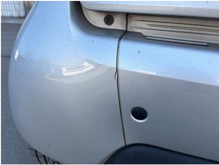
Seitenteil hinten links (Riss/Bruch, Kratzer)
