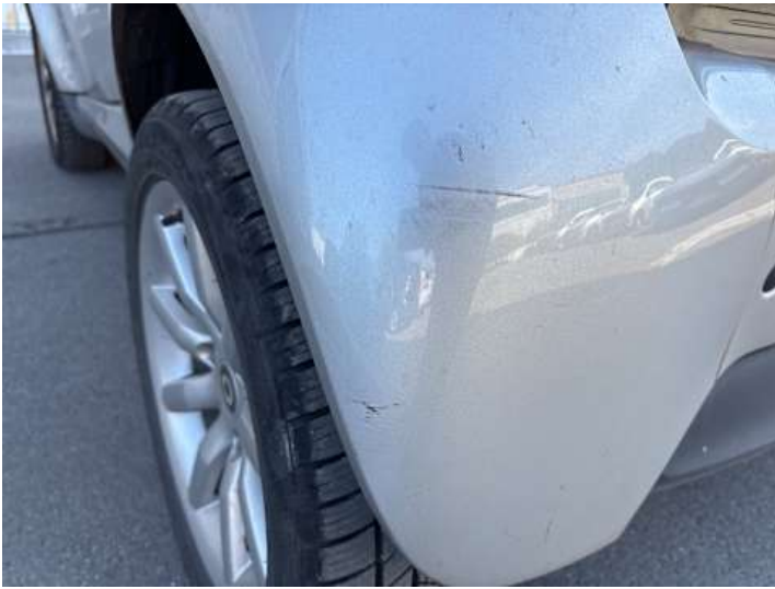
Seitenteil hinten links (Riss/Bruch, Kratzer)
