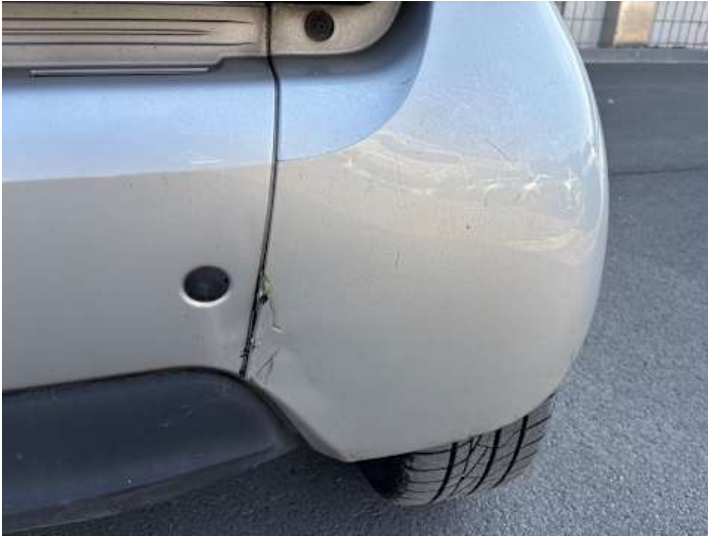
Seitenteil hinten rechts (Kratzer, Riss/Bruch)
