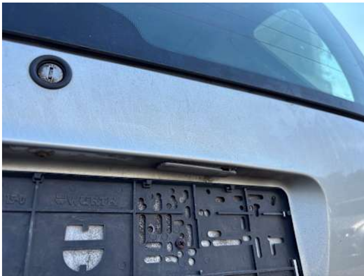
Heckklappe (Anderer Schaden, Kratzer): Genereller Schaden
