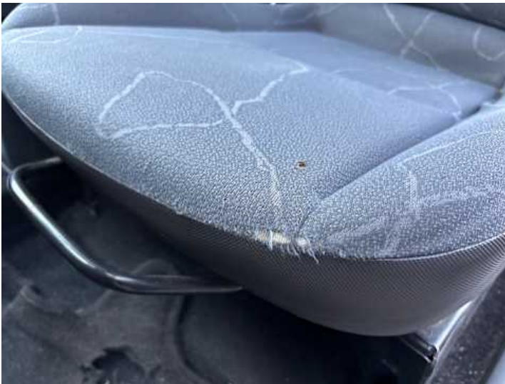
Innenraum (Brandloch, Diverse Schäden, Verschleiß)
