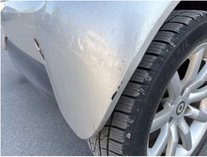
Seitenteil hinten rechts (Kratzer, Riss/Bruch)
