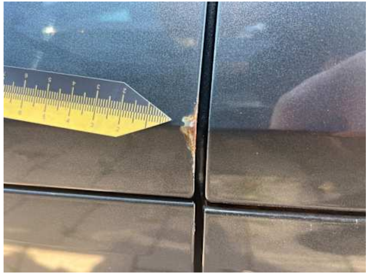
Fahrertür (Lackschaden, Rost)
