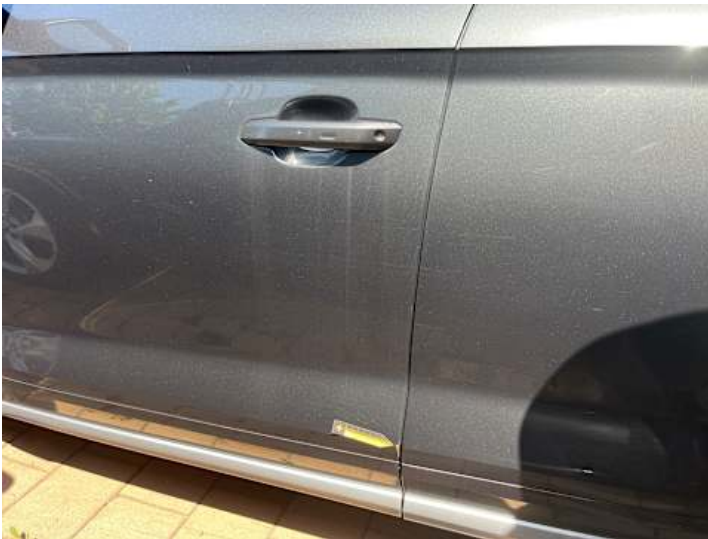
Fahrertür (Lackschaden, Rost)
