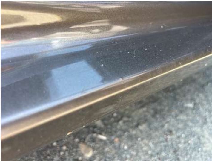
Schweller rechts (Rost)
