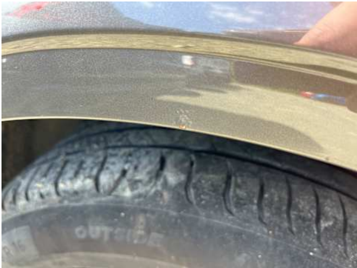
Seitenteil hinten rechts (Rost)
