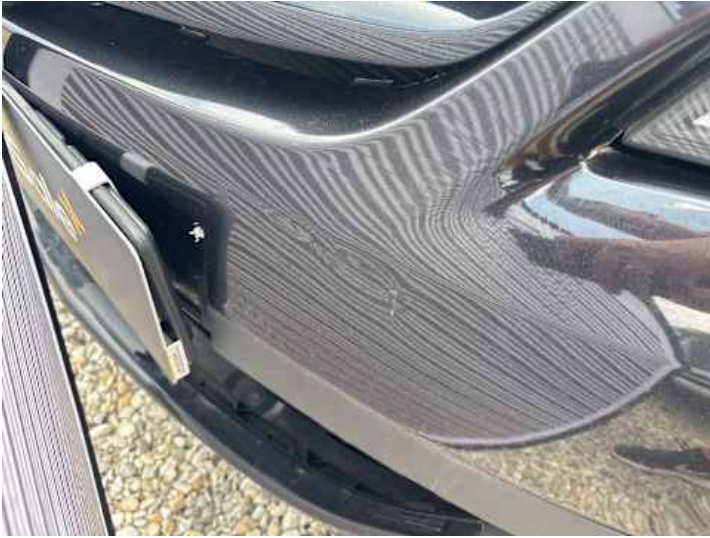
Stoßstange vorne (Verformung, Lackschaden)
