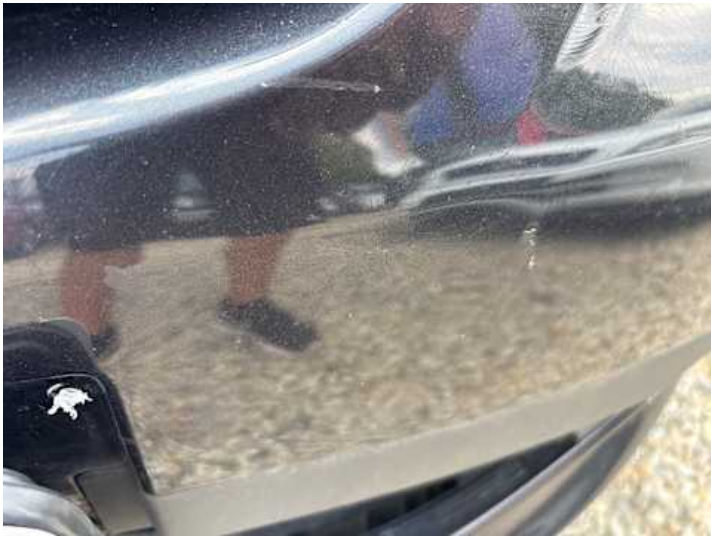
Stoßstange vorne (Verformung, Lackschaden)
