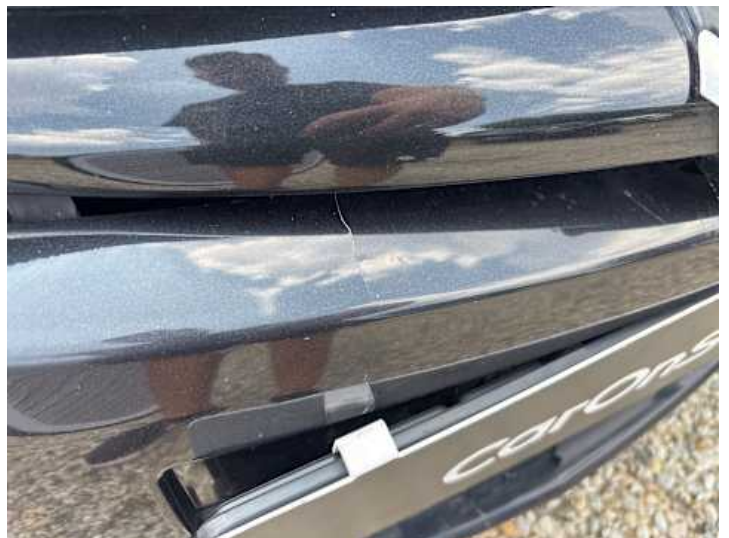
Stoßstange vorne (Riss/Bruch, Kratzer)
