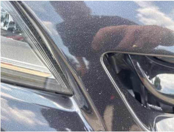
Stoßstange vorne (Verformung, Lackschaden)
