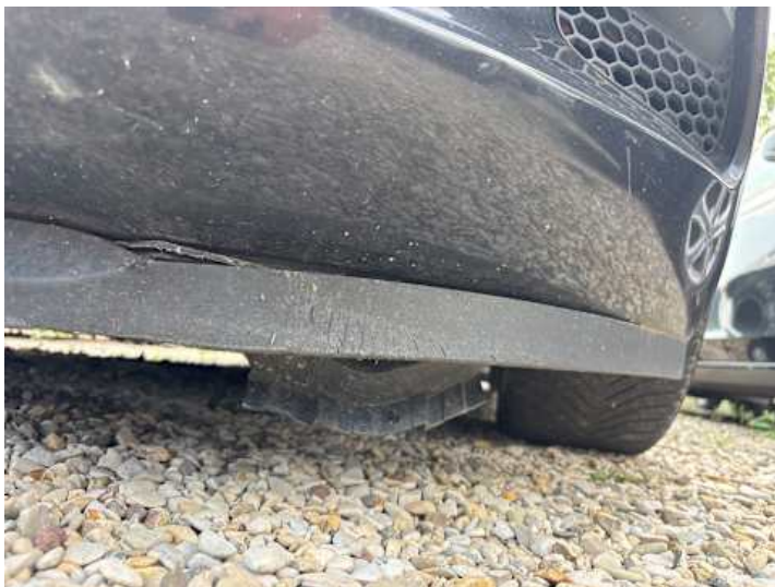
Stoßstange vorne (Riss/Bruch, Kratzer)
