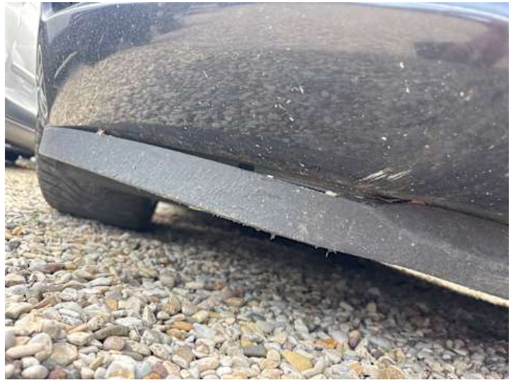
Stoßstange vorne (Riss/Bruch, Kratzer)
