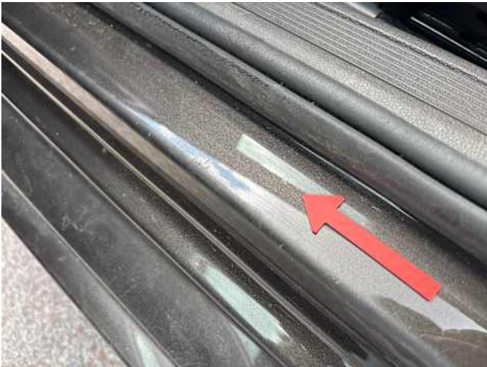
Schweller links (Rost)
