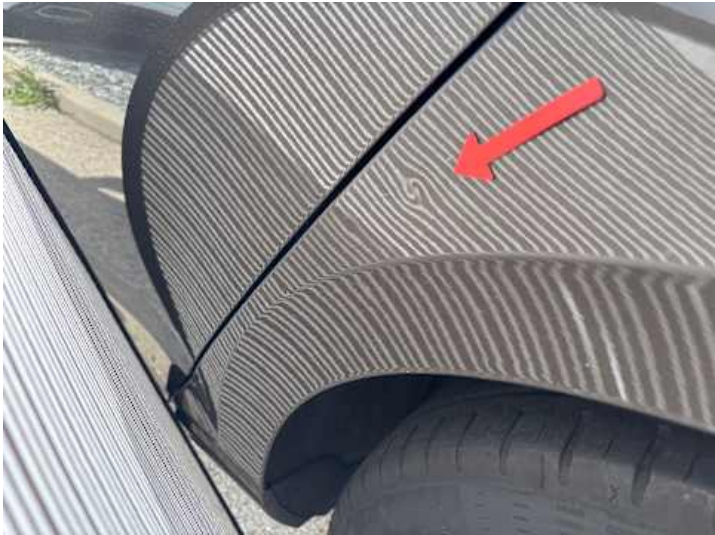
Seitenteil hinten links (Delle)
