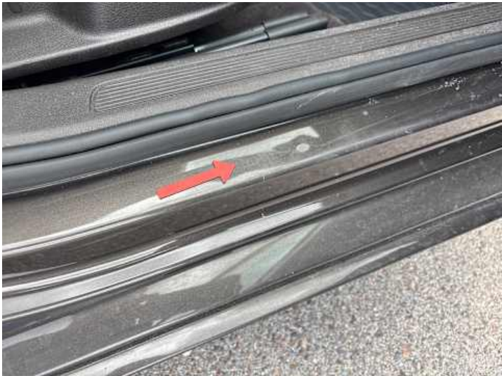
Schweller rechts (Delle, Rost)
