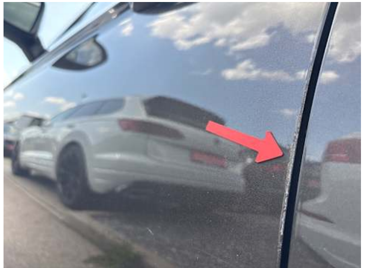
Fahrtür (Kratzer, Lackschaden, Unsachgemäß instand gesetzt)
