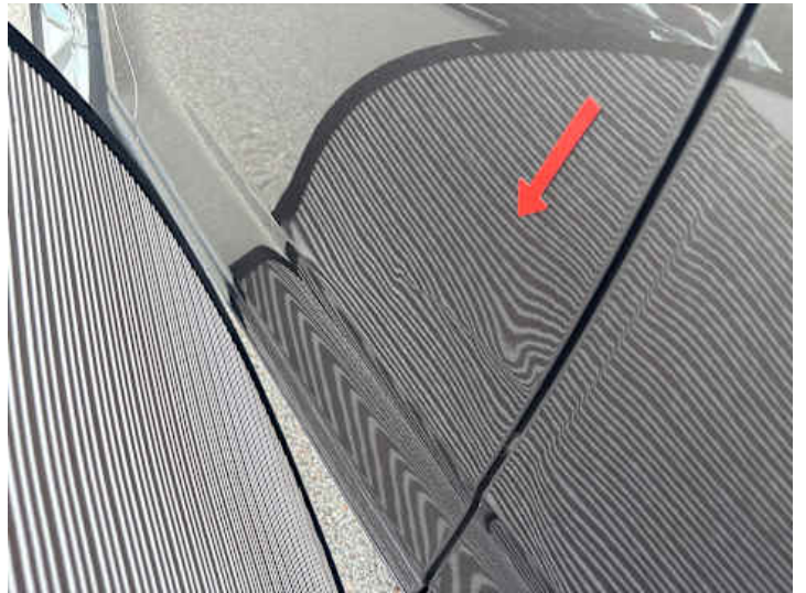
Türe hinten rechts (Verformung)
