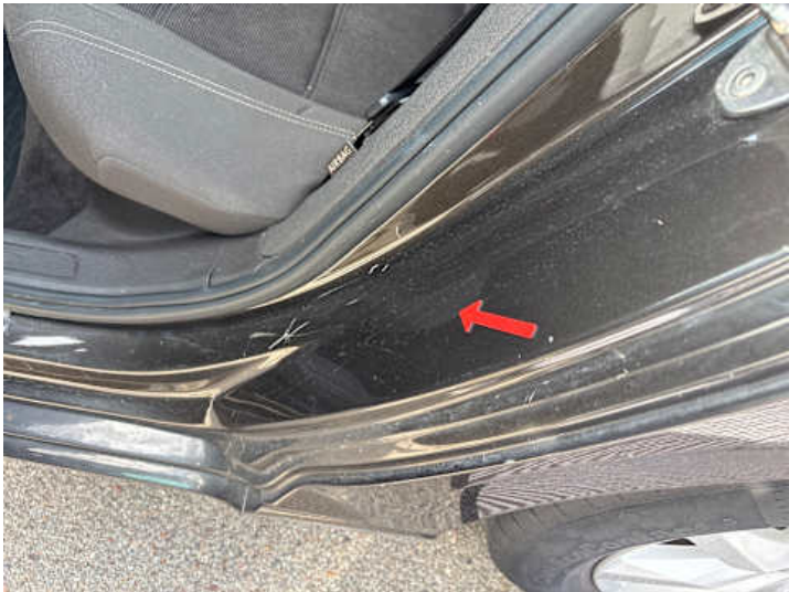
Seitenteil hinten links (Kratzer, Delle)
