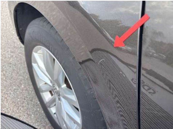
Seitenteil hinten rechts (Kratzer)
