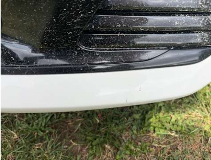
Stoßstange vorne (Kratzer, Lackschaden)
