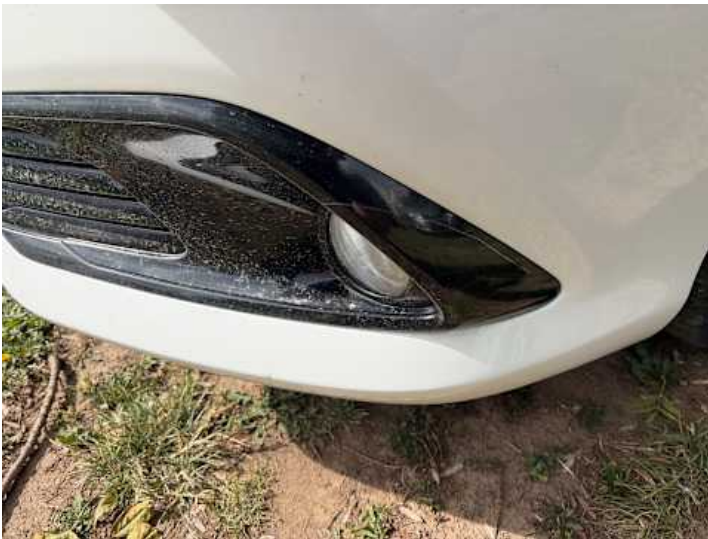
Stoßstange vorne (Kratzer, Verformung)
