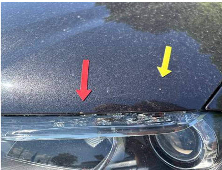
Motorhaube (Rost, Lackschaden)
