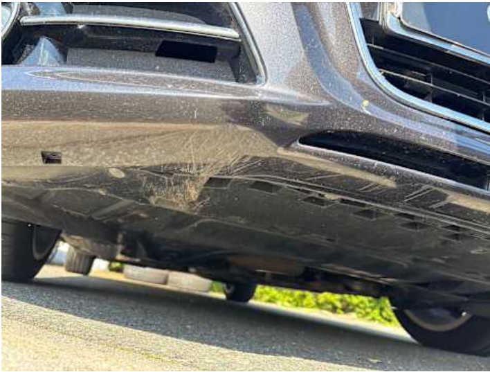
Stoßstange vorne (Kratzer, Lackschaden)
