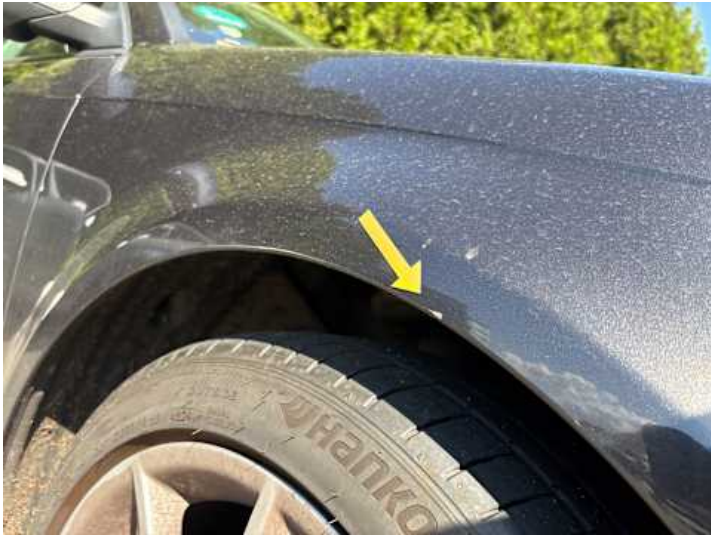
Kotflügel vorne rechts (Lackschaden)
