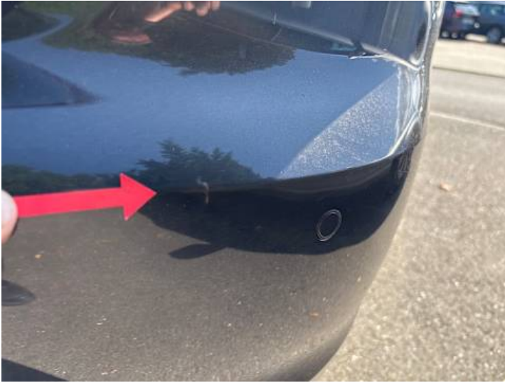
Stoßstange hinten (Kratzer, Lackschaden)
