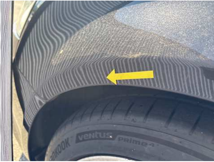
Kotflügel vorne links (Delle)
