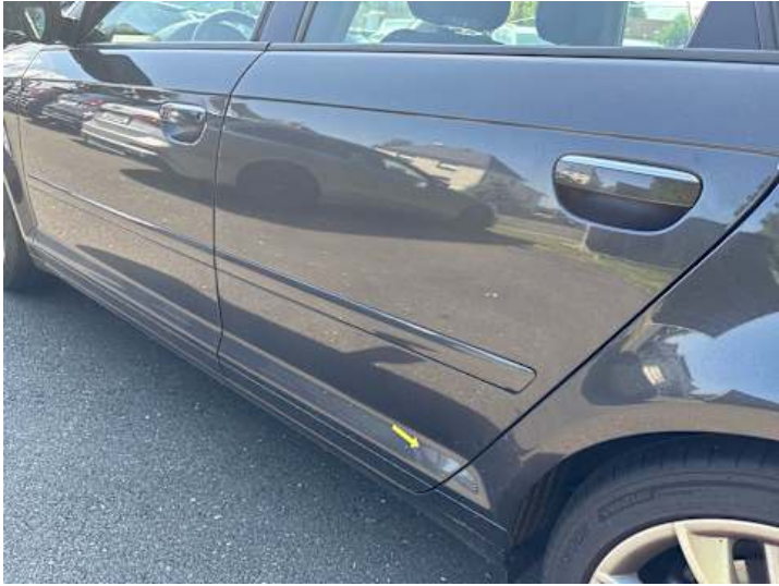
Türe hinten links (Rost)
