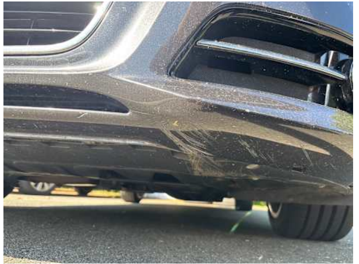
Stoßstange vorne (Kratzer, Lackschaden)
