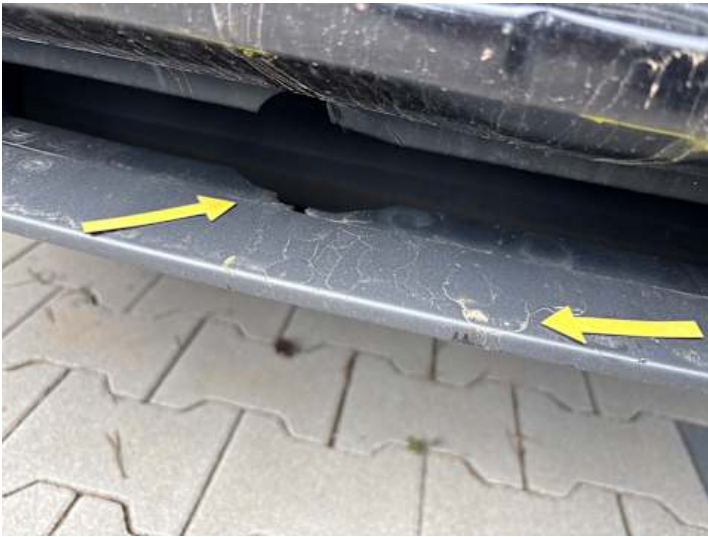
Stoßstange vorne (Riss/Bruch, Kratzer)
