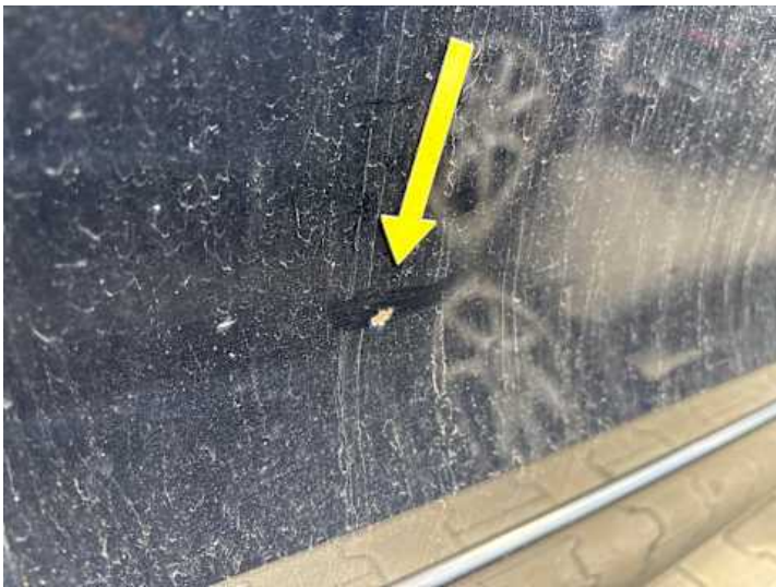
Beifahrertür (Rost, Lackschaden)
