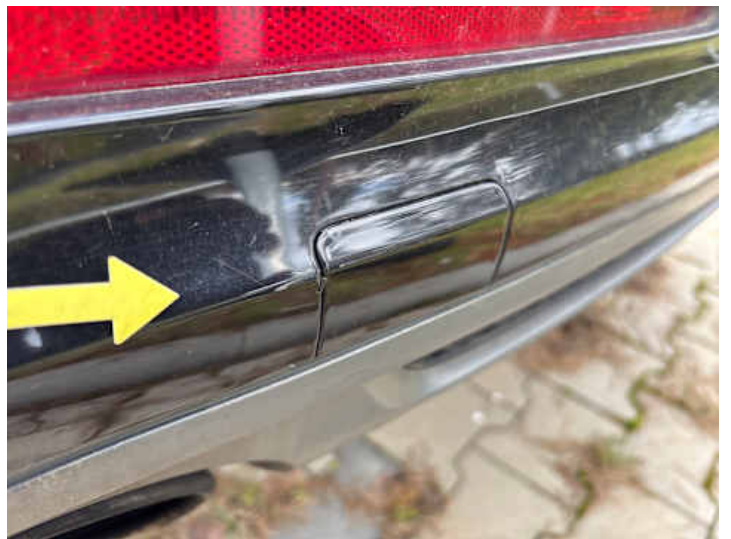
Stoßstange hinten (Kratzer, Lackschaden)
