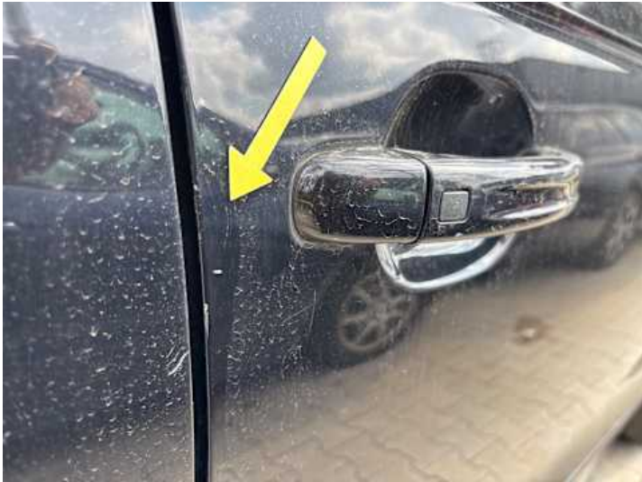
Beifahrtür (Lackschaden, Kratzer)
