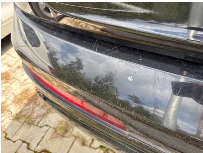
Stoßstange hinten (Kratzer, Lackschaden)
