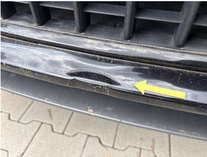
Stoßstange vorne (Lackschaden, Verformung)
