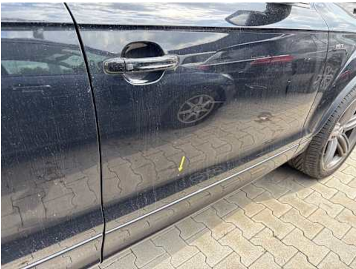
Beifahrertür (Rost, Lackschaden)
