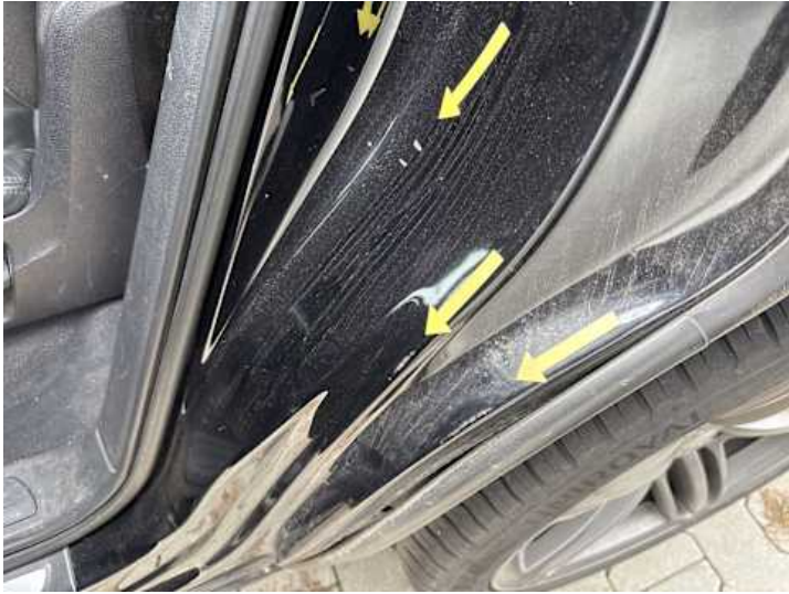
Türe hinten links (Kratzer, Lackschaden)
