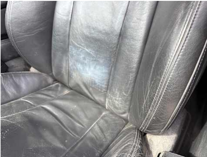
Innenraum (Verschleiß, Kratzer, Verschmutzung)
