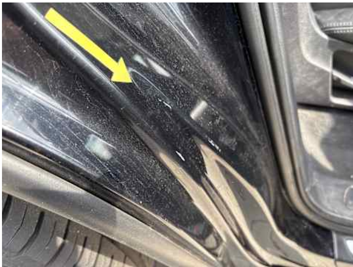
Türe hinten rechts (Lackschaden, Kratzer)
