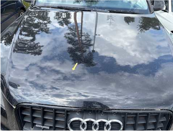
Motorhaube (Steinschlag, Lackschaden)
