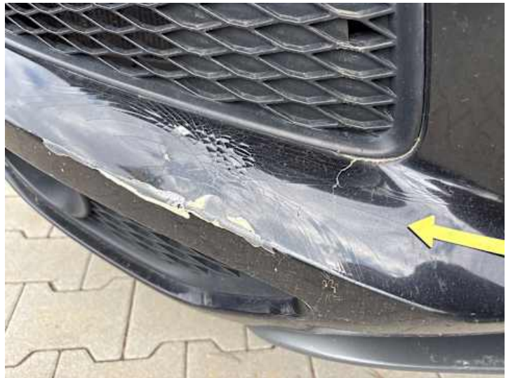
Stoßstange vorne (Lackschaden, Kratzer, Verformung, Riss/Bruch)
