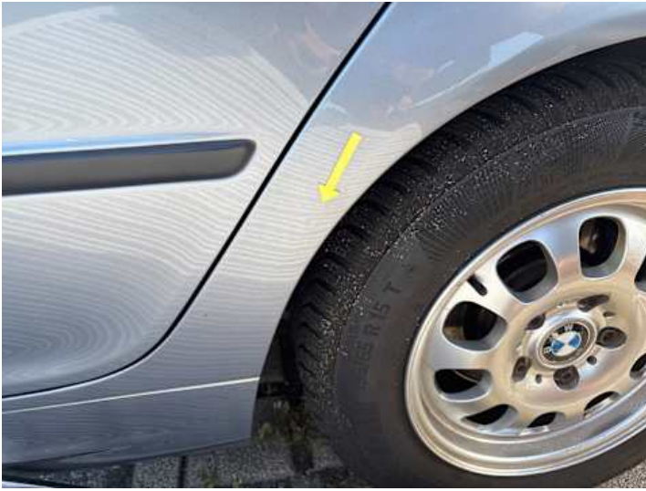
Seitenteil hinten links (Rost, Delle)
