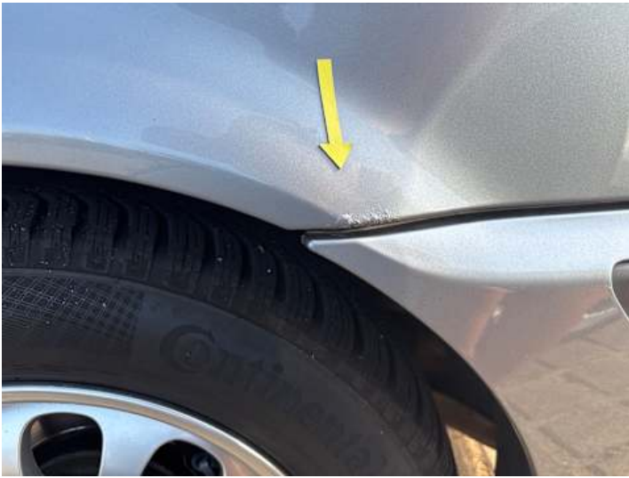
Seitenteil hinten links (Rost, Delle)
