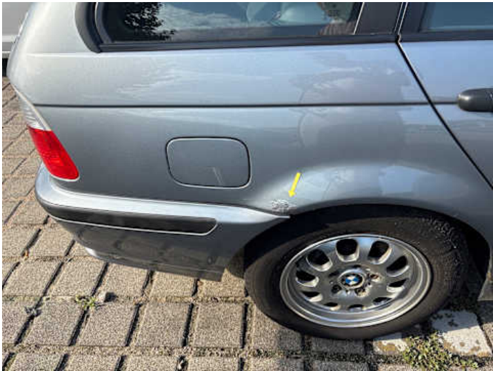
Seitenteil hinten rechts (Rost)
