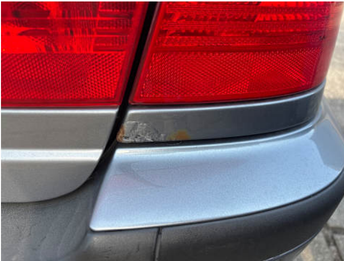
Seitenteil hinten rechts (Rost)
