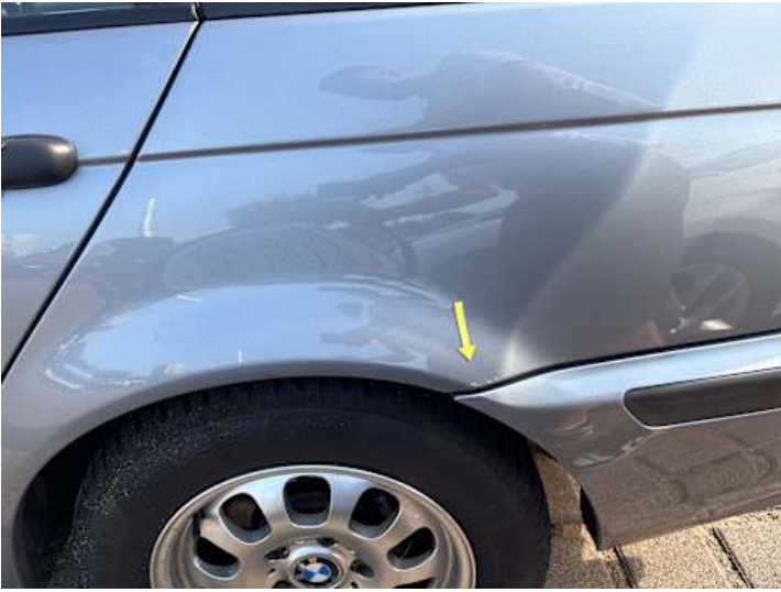
Seitenteil hinten links (Rost, Delle)
