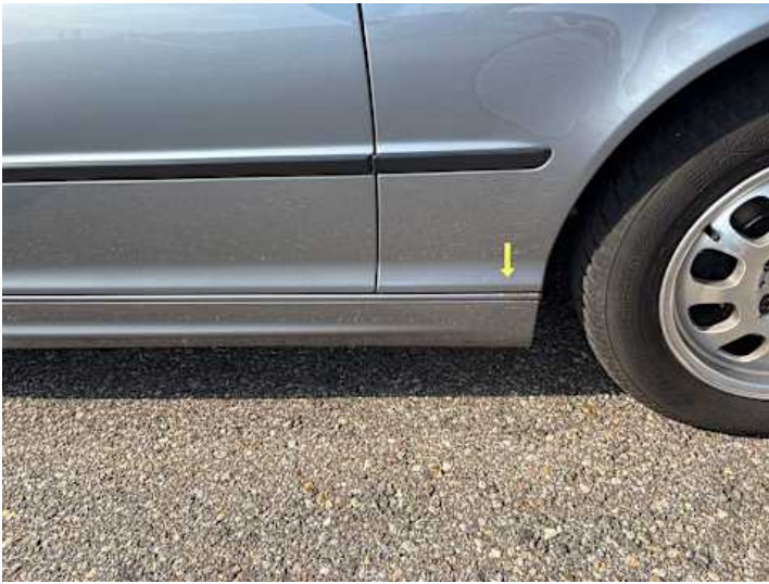
Schweller rechts (Rost)
