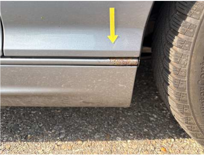
Schweller rechts (Rost)
