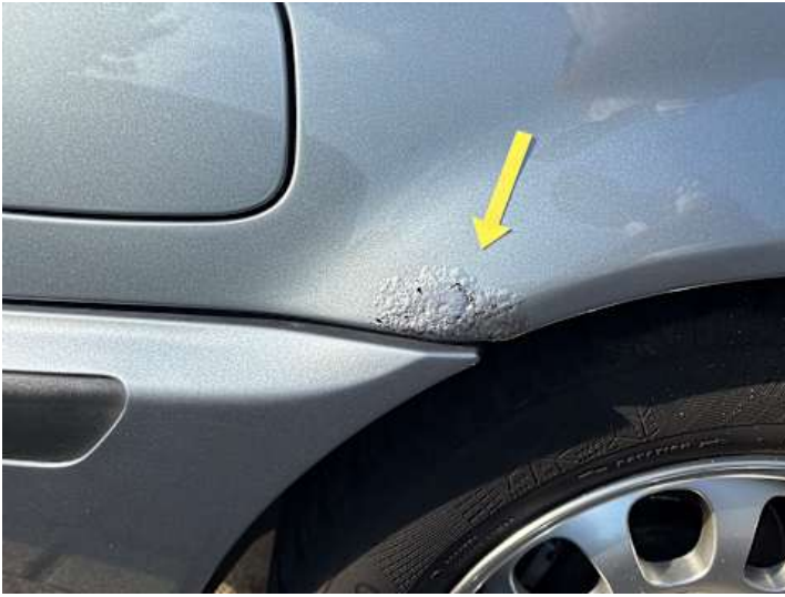
Seitenteil hinten rechts (Rost)
