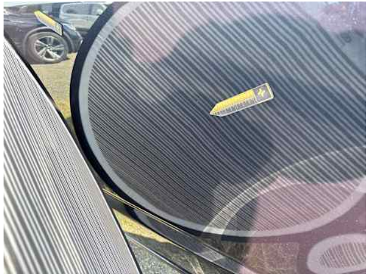
Seitenteil hinten links (Unsachgemäß instand gesetzt, Verformung)
