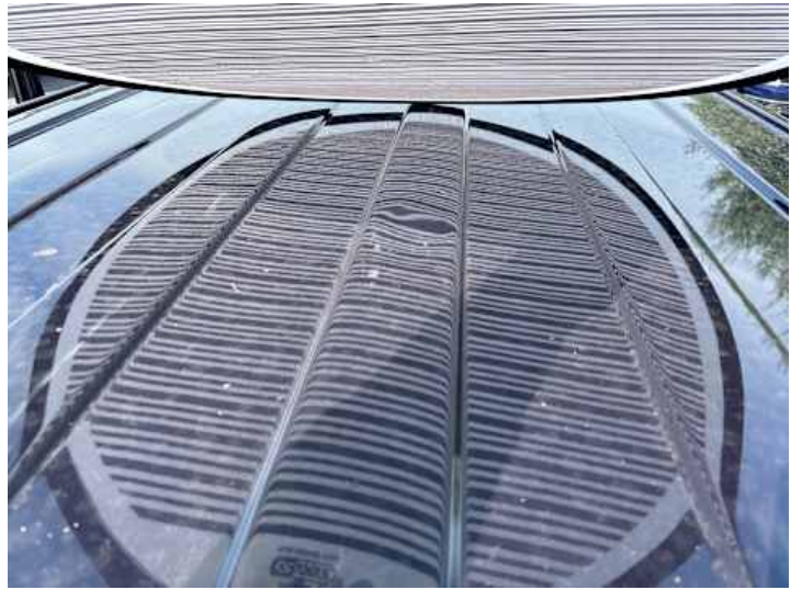
Dach (Verformung, Lackschaden)
