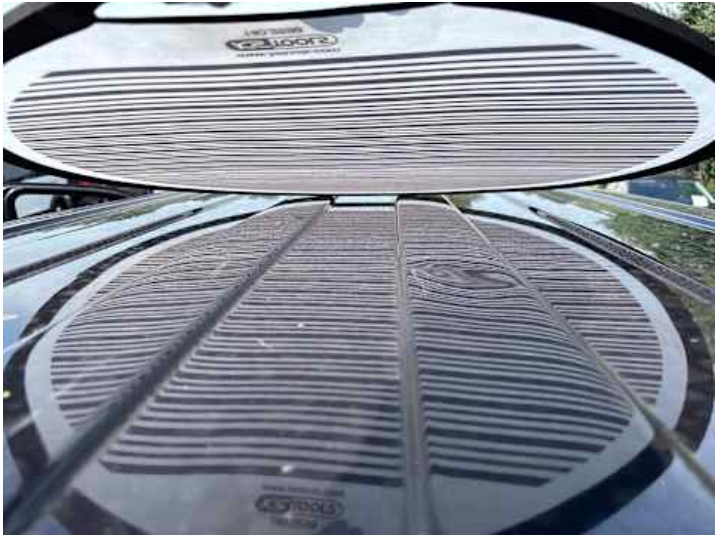
Dach (Verformung, Lackschaden)
