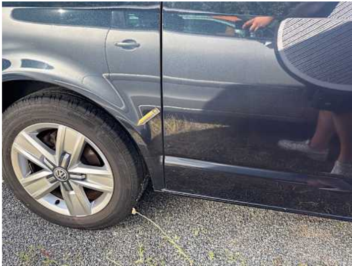
Seitenteil hinten rechts (Kratzer)
