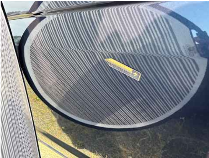
Seitenteil hinten links (Unsachgemäß instand gesetzt, Verformung)
