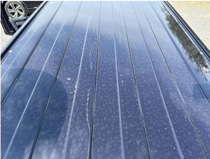
Dach (Verformung, Lackschaden)
