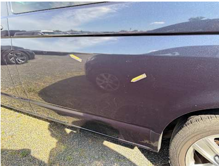
Seitenteil hinten links (Unsachgemäß instand gesetzt, Verformung)
