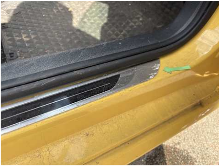
Schweller rechts (Kratzer, Rost)
