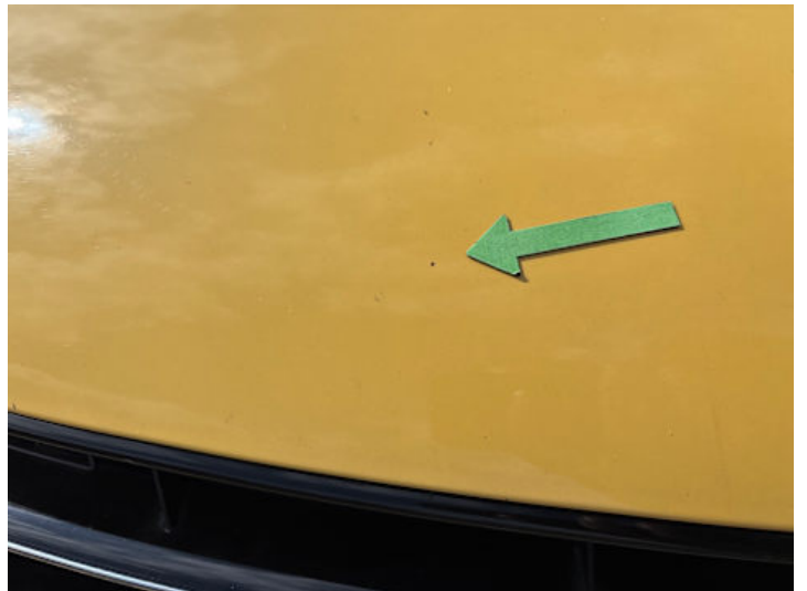
Motorhaube (Steinschlag, Rost)
