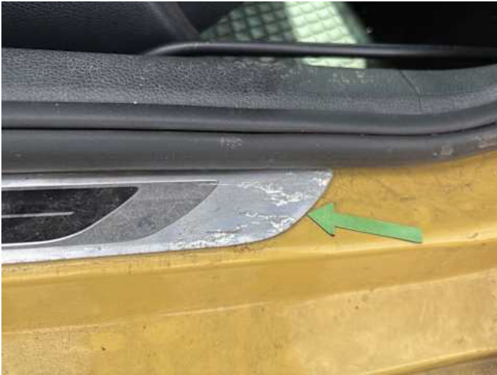
Schweller links (Rost)
