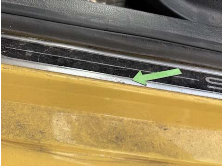
Schweller links (Rost)
