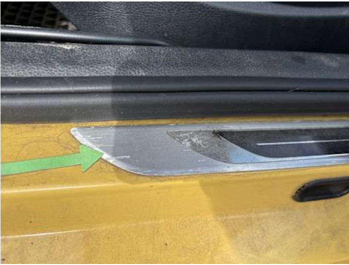
Schweller rechts (Kratzer, Rost)
