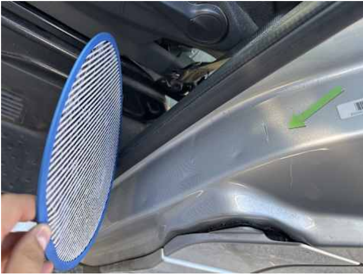
Fahrtür (Delle, Kratzer)
