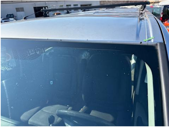
Dach (Lackschaden, Rost)
