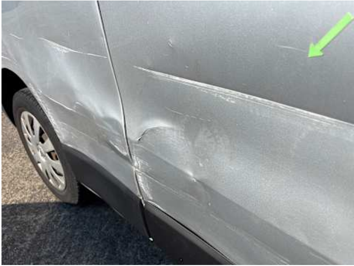
Türe hinten rechts (Lackschaden, Verformung, Riss/Bruch)
