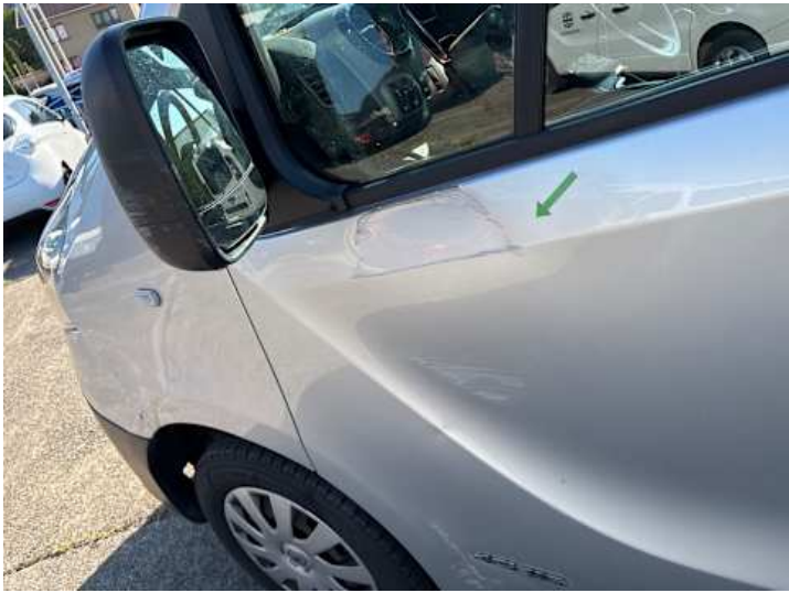
Fahrtür (Lackschaden, Verformung)
