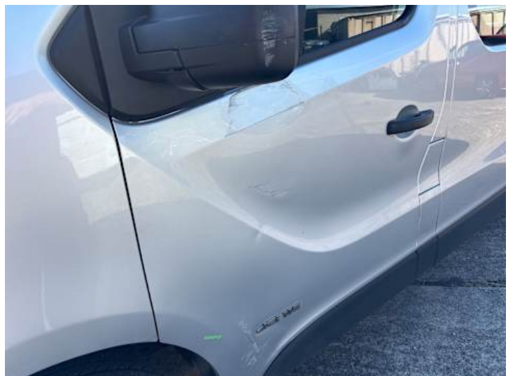
Fahrtür (Lackschaden, Verformung)
