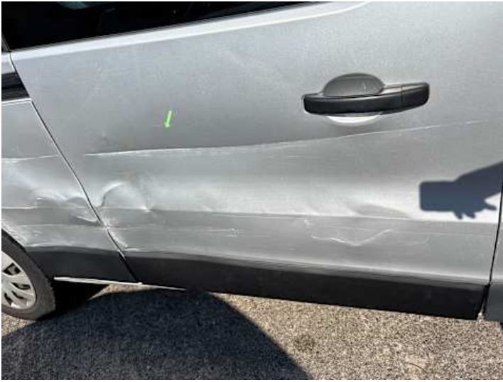
Türe hinten rechts (Lackschaden, Verformung, Riss/Bruch)
