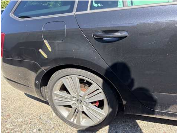
Seitenteil hinten rechts (Delle, Lackschaden)
