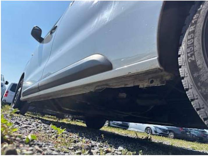
Schweller links (Verformung)
