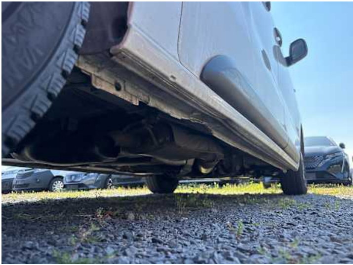
Schweller rechts (Verformung)
