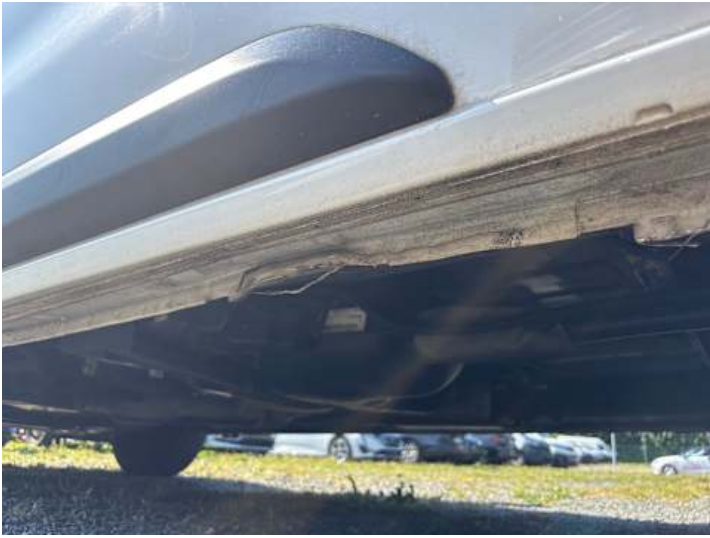
Schweller links (Verformung)
