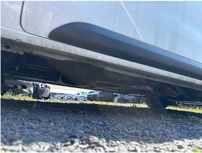
Schweller rechts (Verformung)
