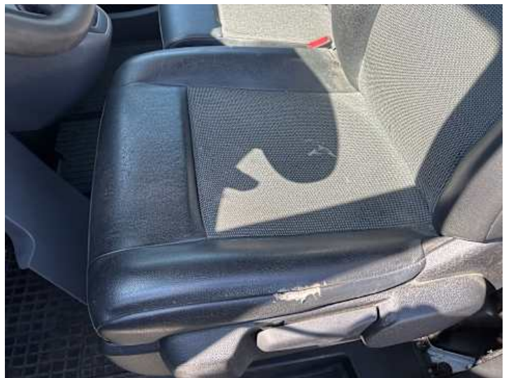
Innenraum (Verschleiß, Riss/Bruch, Verschmutzung)
