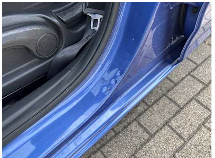
Schweller links (Kratzer, Delle)
