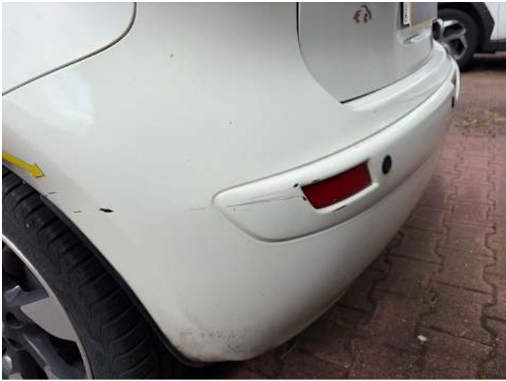
Stoßstange hinten (Kratzer, Lackschaden)
