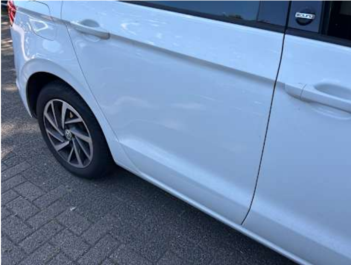
Türe hinten rechts (Verformung, Kratzer)
