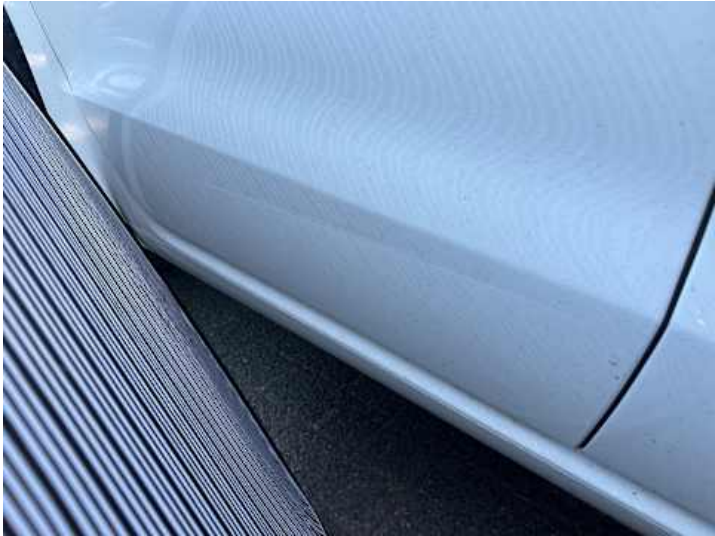
Türe hinten rechts (Verformung, Kratzer)
