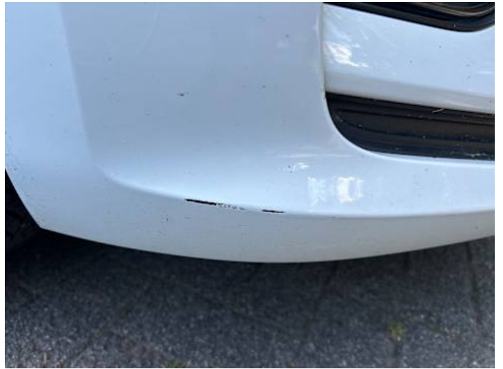
Stoßstange vorne (Riss/Bruch, Spaltmaße ungenau, Lackschaden)
