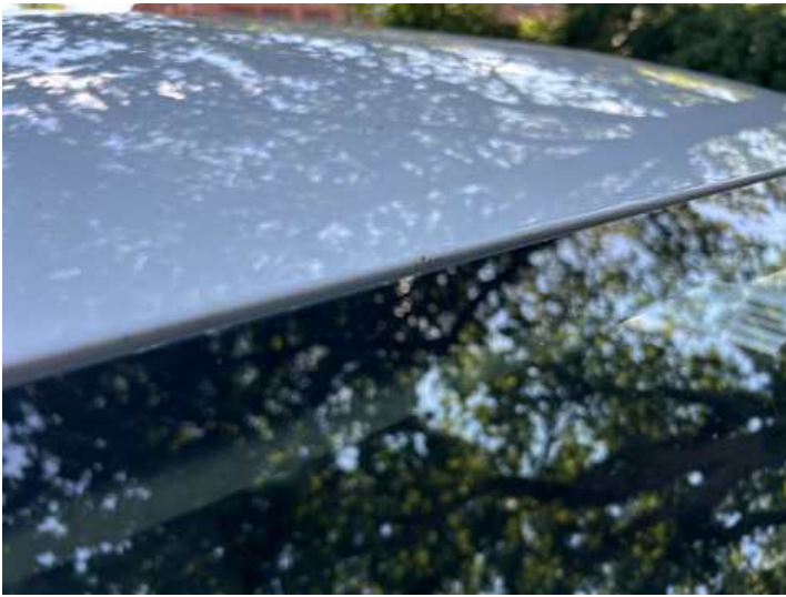
Dach (Steinschlag, Delle)
