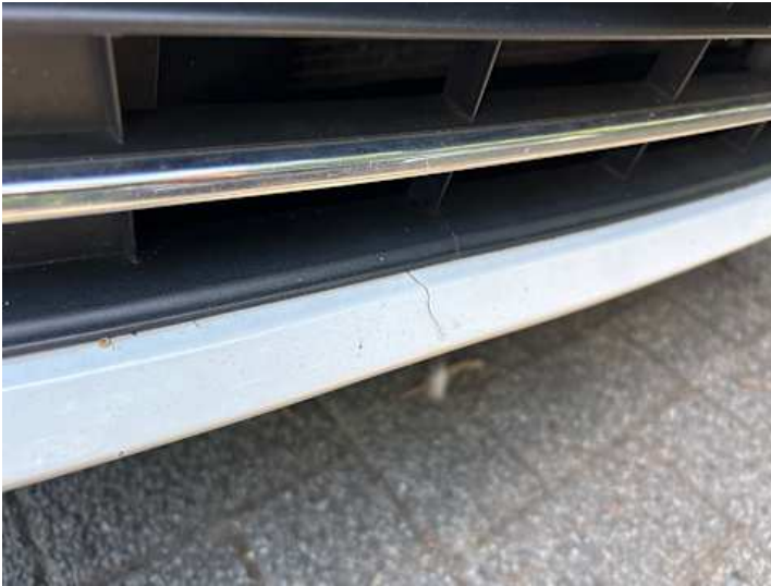
Stoßstange vorne (Riss/Bruch, Spaltmaße ungenau, Lackschaden)
