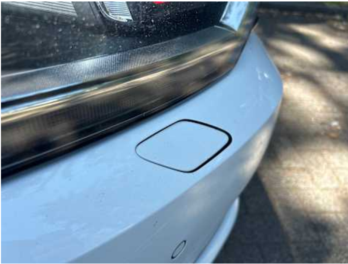
Stoßstange vorne (Riss/Bruch, Spaltmaße ungenau, Lackschaden)
