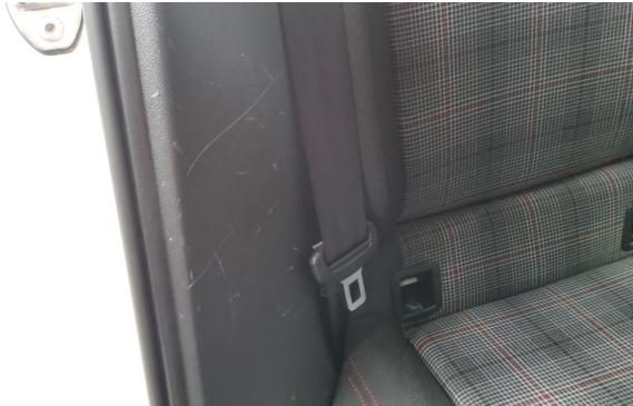
Verkleidung Einstieg HR zerkratzt ern
