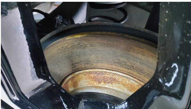
Bremsscheiben hinten Rostansatz, freibremsen
