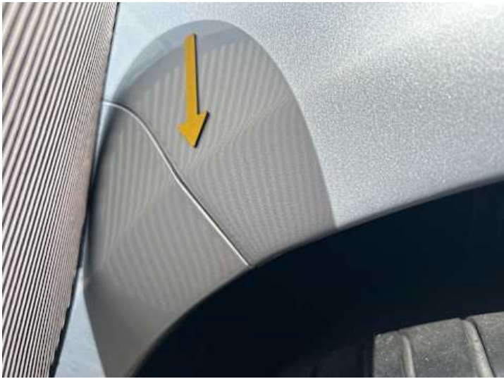
Seitenteil hinten rechts (Rost, Unsachgemäß instand gesetzt)
