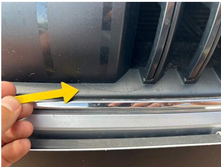
Stoßstange vorne (Riss/Bruch)
