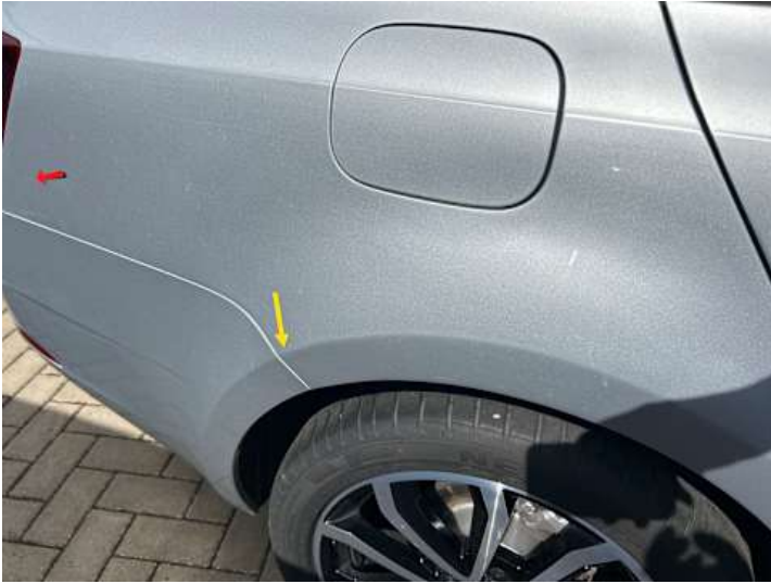
Seitenteil hinten rechts (Rost, Unsachgemäß instand gesetzt)
