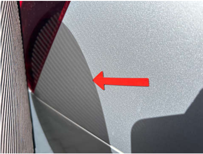
Seitenteil hinten rechts (Rost, Unsachgemäß instand gesetzt)
