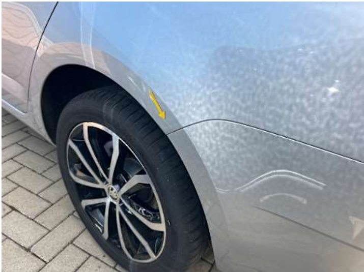
Seitenteil hinten links (Rost, Kratzer)
