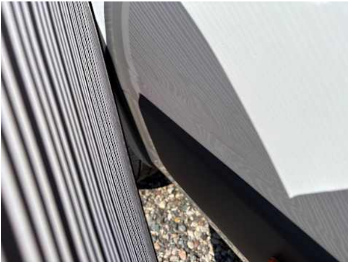
Seitenteil hinten rechts (Verformung, Lackschaden, Kratzer)
