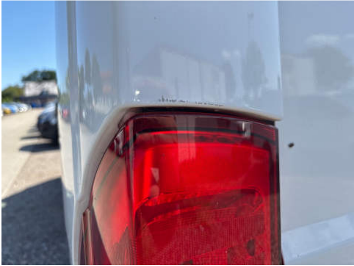
Seitenteil hinten links (Verformung, Lackschaden)
