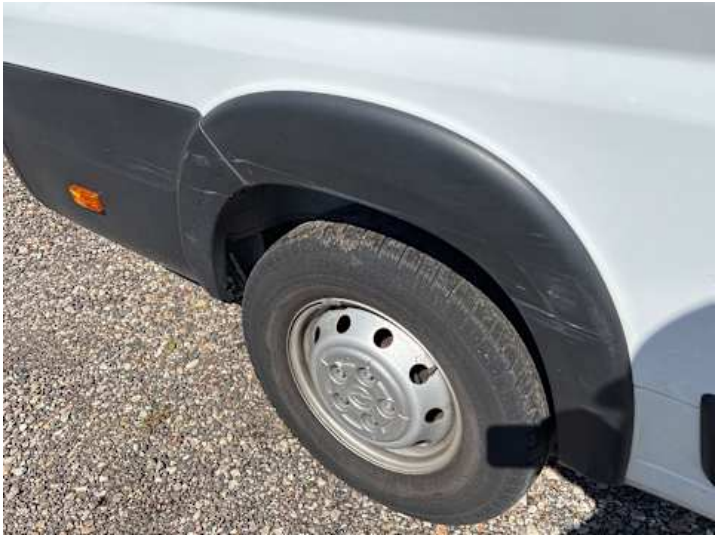
Seitenteil hinten rechts (Verformung, Lackschaden, Kratzer)
