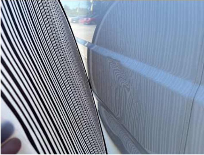
Seitenteil hinten links (Verformung, Lackschaden)
