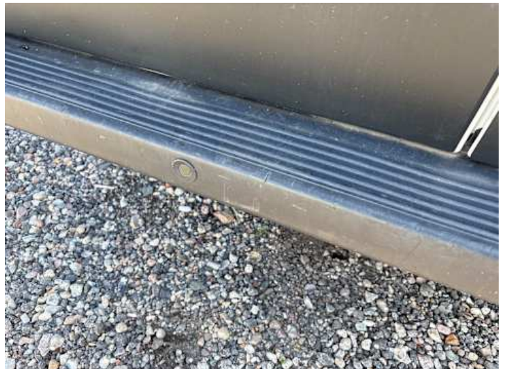
Stoßstange hinten (Kratzer, Lackschaden)
