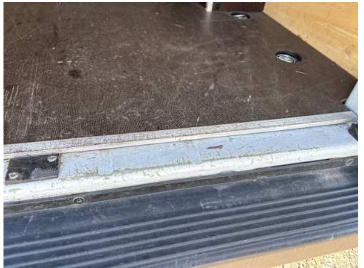
Stoßstange hinten (Kratzer, Lackschaden)
