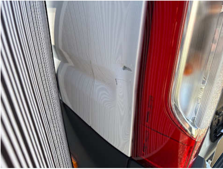
Seitenteil hinten links (Verformung, Lackschaden)
