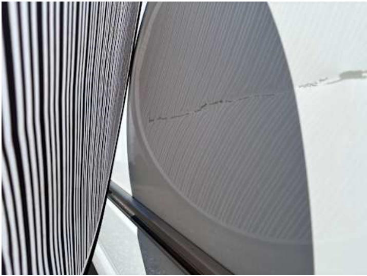
Seitenteil hinten rechts (Verformung, Lackschaden, Kratzer)
