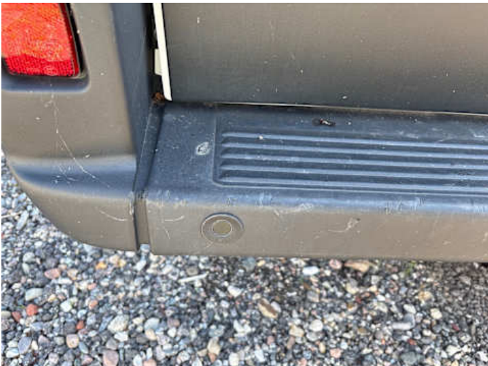
Stoßstange hinten (Kratzer, Lackschaden)
