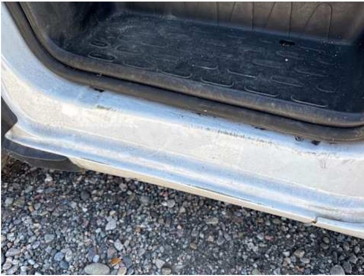
Schweller links (Lackschaden)
