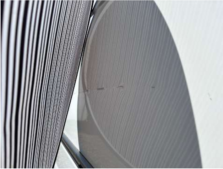
Seitenteil hinten rechts (Verformung, Lackschaden, Kratzer)
