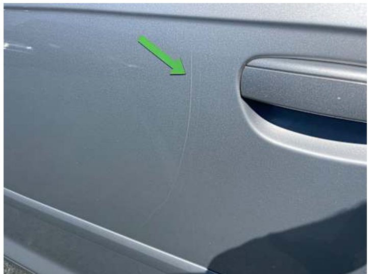
Fahrertür (Lackschaden, Kratzer)
