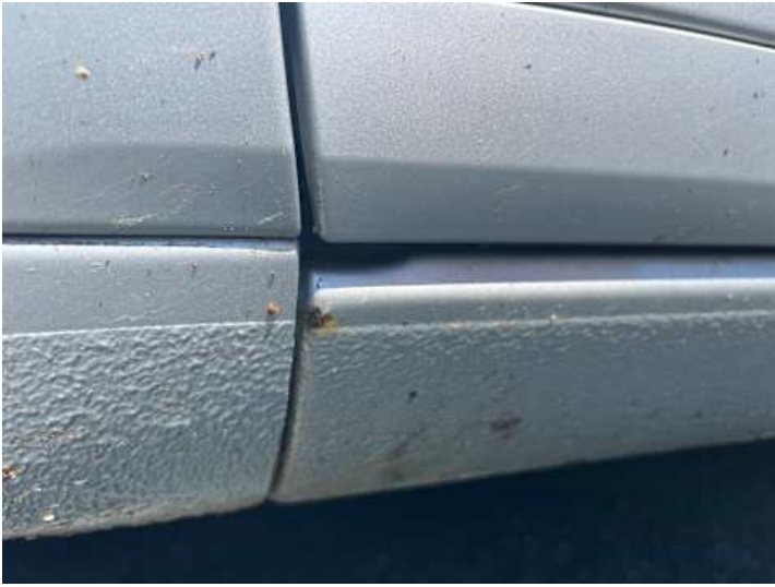
Schweller links (Rost)
