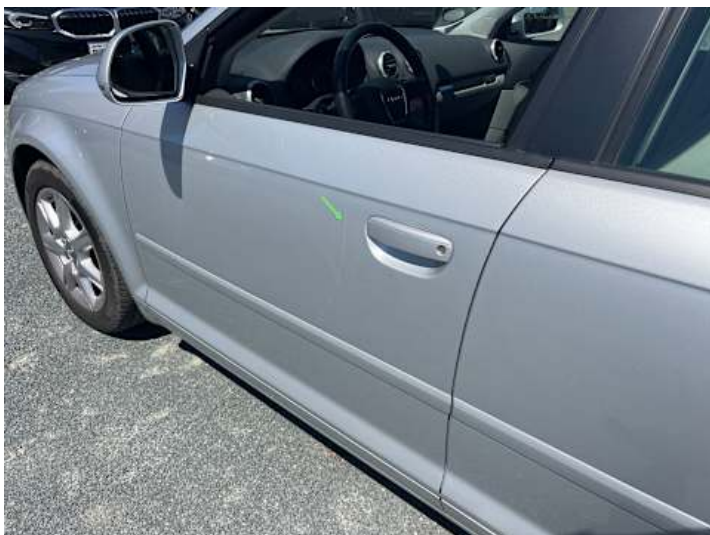
Fahrertür (Lackschaden, Kratzer)
