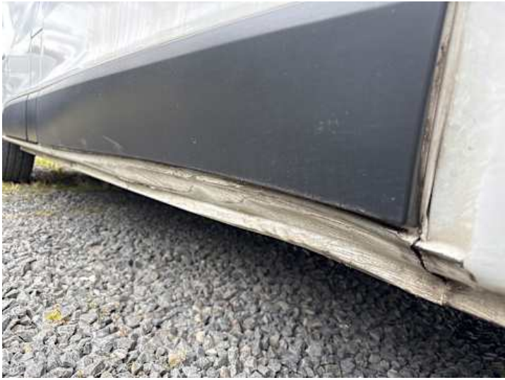
Schweller links (Verformung, Kratzer)
