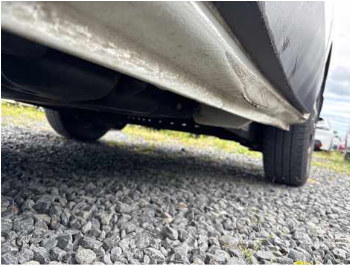
Schweller links (Verformung, Kratzer)
