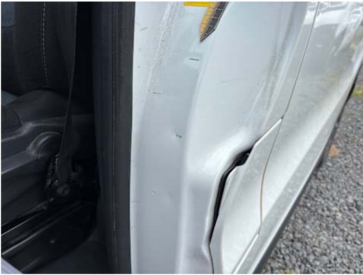
Schweller links (Kratzer, Delle)
