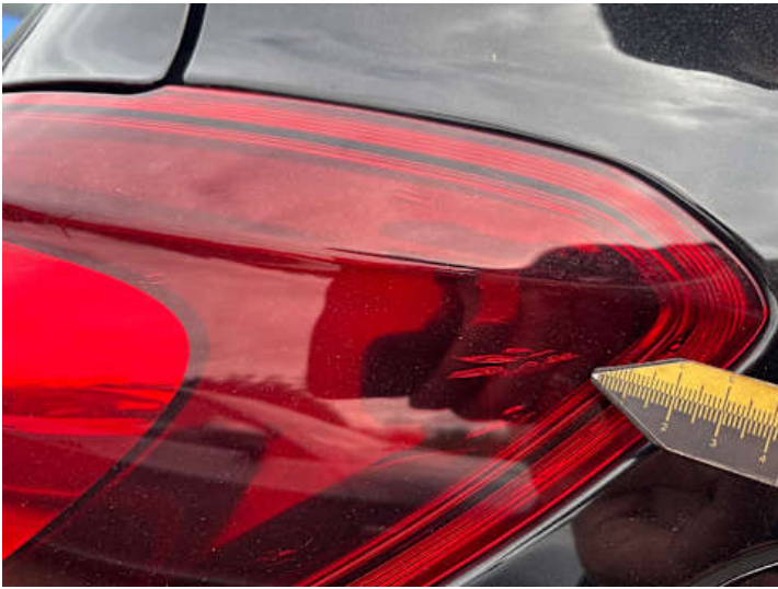
Rücklicht (rechts) (Riss/Bruch)
