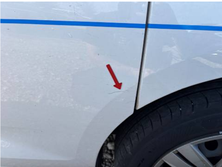
Türe hinten links (Kratzer, Lackschaden)
