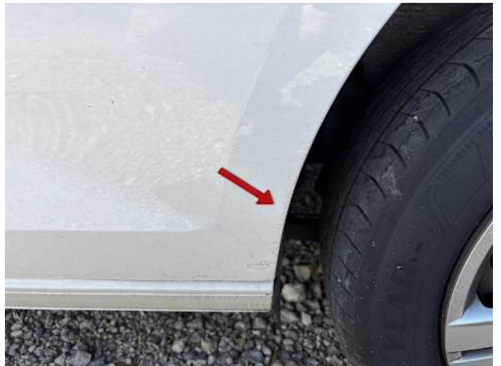
Türe hinten links (Kratzer, Lackschaden)
