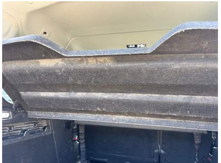
Innenraum (Verschmutzung, Verschleiß, Kratzer, Anderer Schaden): Schimmel
