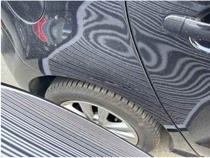
Seitenteil hinten rechts (Delle)
