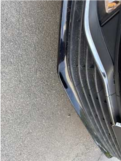
Stoßstange vorne (Delle)
