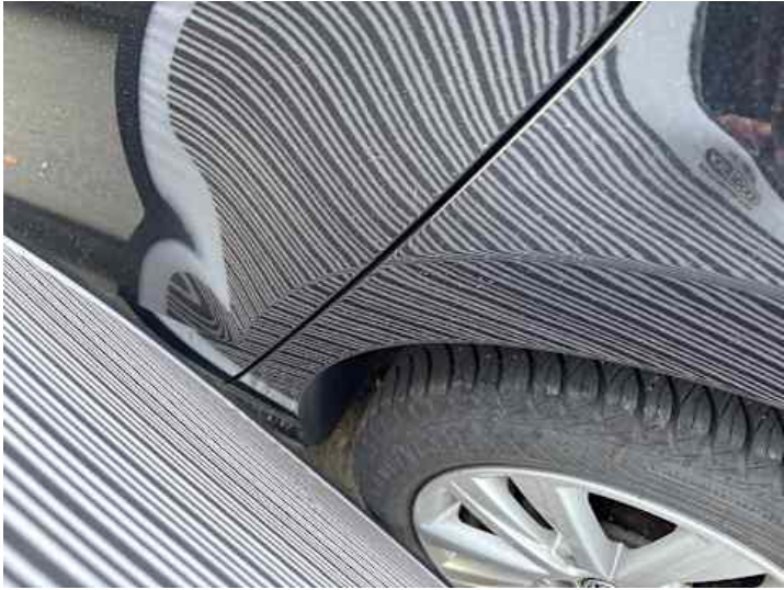
Seitenteil hinten links (Delle)
