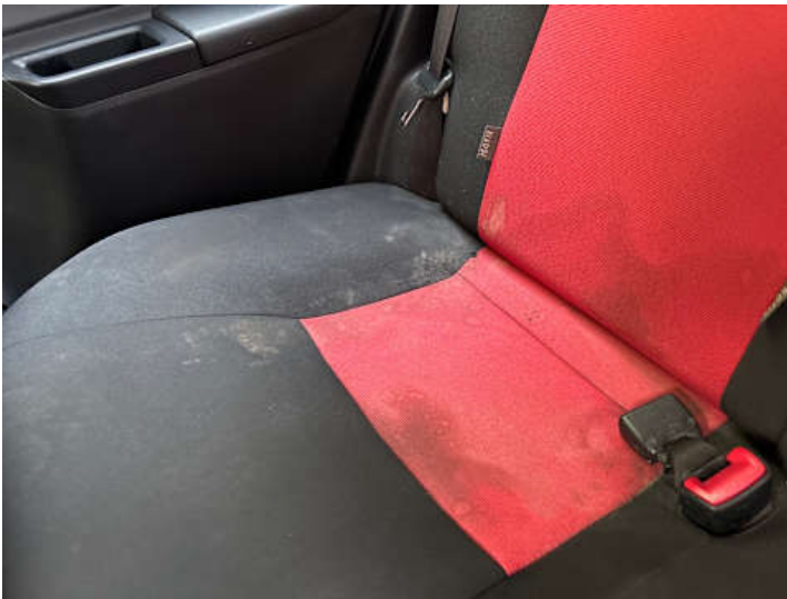
Innenraum (Brandloch, Verschmutzung)
