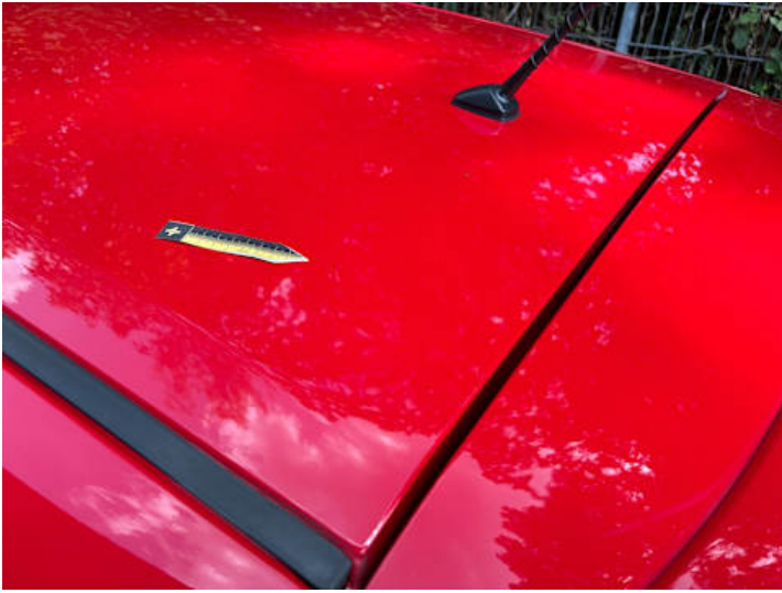
Dach (Lackschaden, Kratzer)
