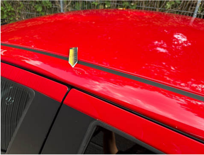
Dach (Delle, Lackschaden)
