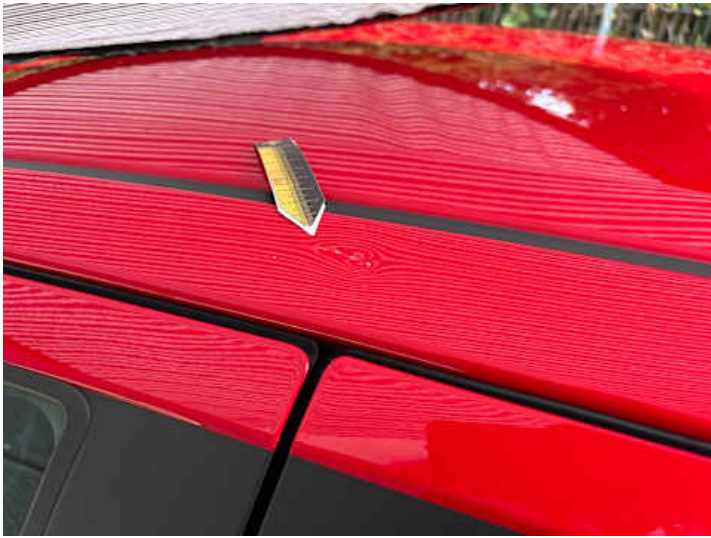
Dach (Delle, Lackschaden)
