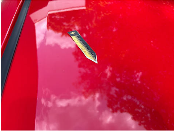
Dach (Lackschaden, Kratzer)
