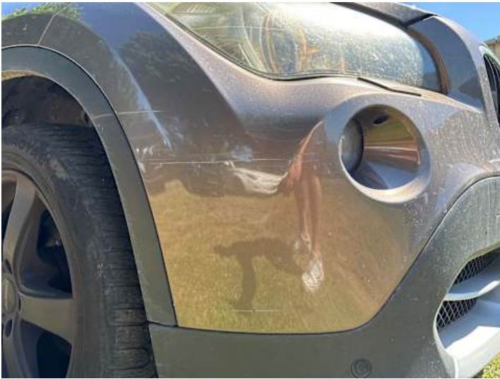
Stoßstange vorne (Lackschaden, Kratzer)
