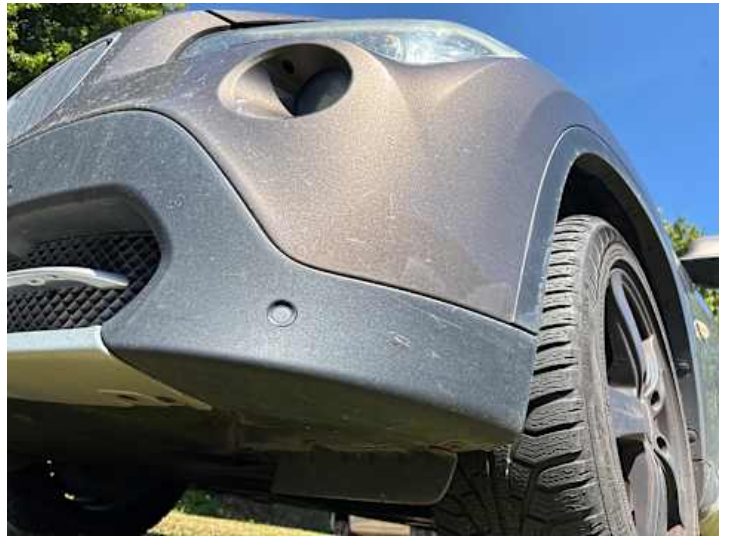
Stoßstange vorne (Lackschaden, Kratzer)
