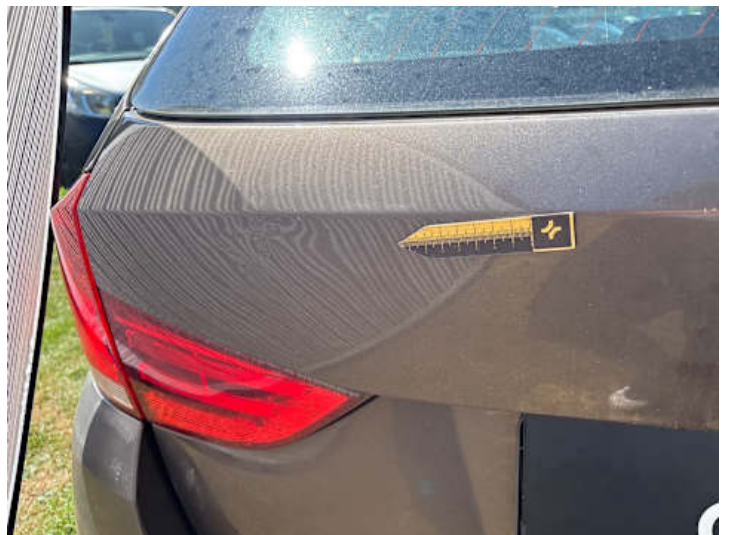
Heckklappe (Lackschaden, Verformung)
