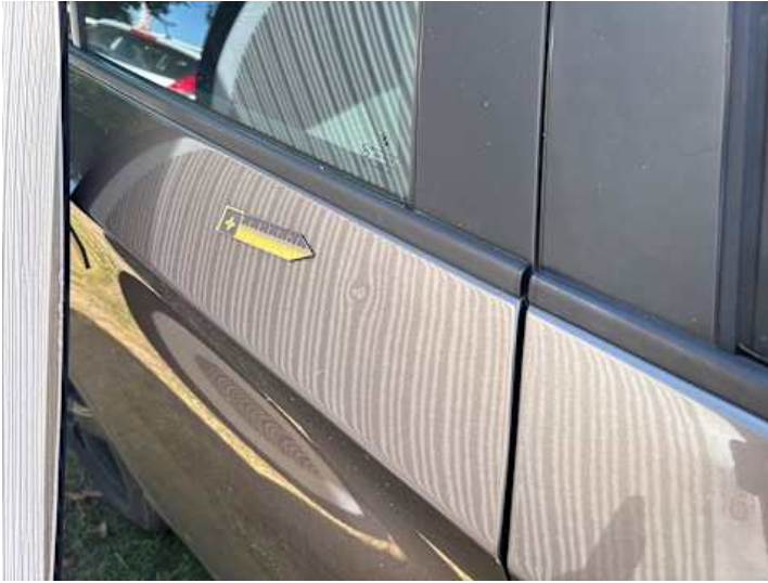
Türe hinten rechts (Lackschaden, Delle)
