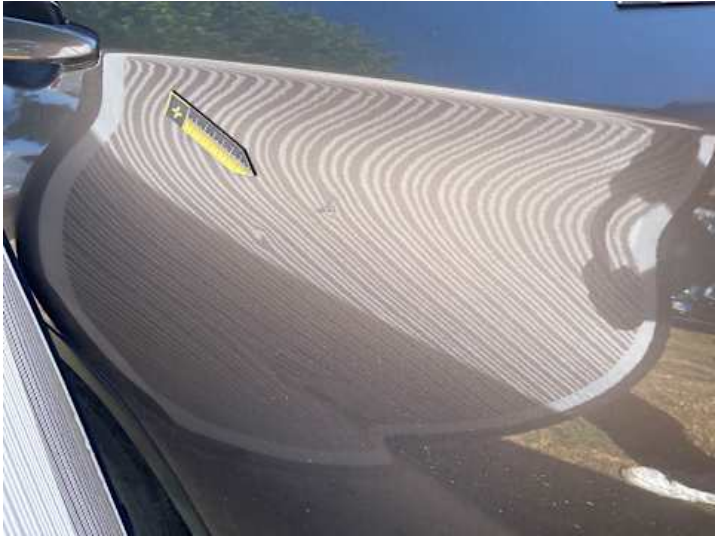
Türe hinten rechts (Lackschaden, Delle)
