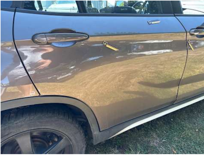
Türe hinten rechts (Lackschaden, Delle)
