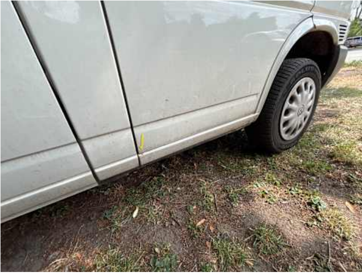
Schweller rechts (Rost)
