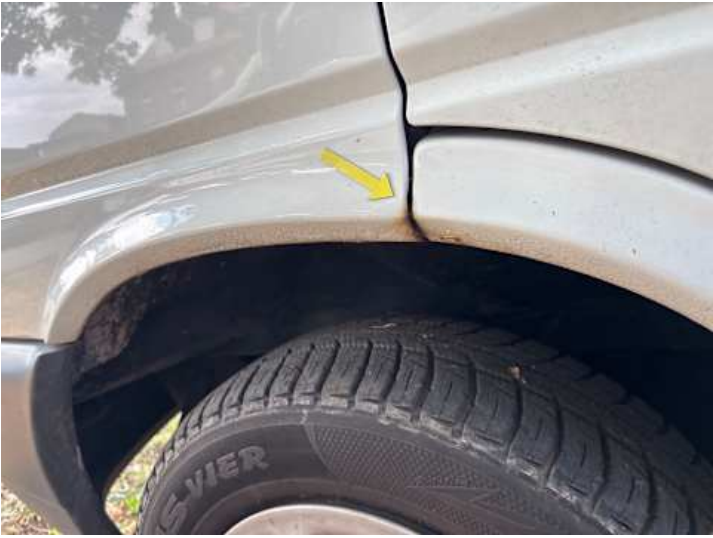
Kotflügel vorne links (Rost)
