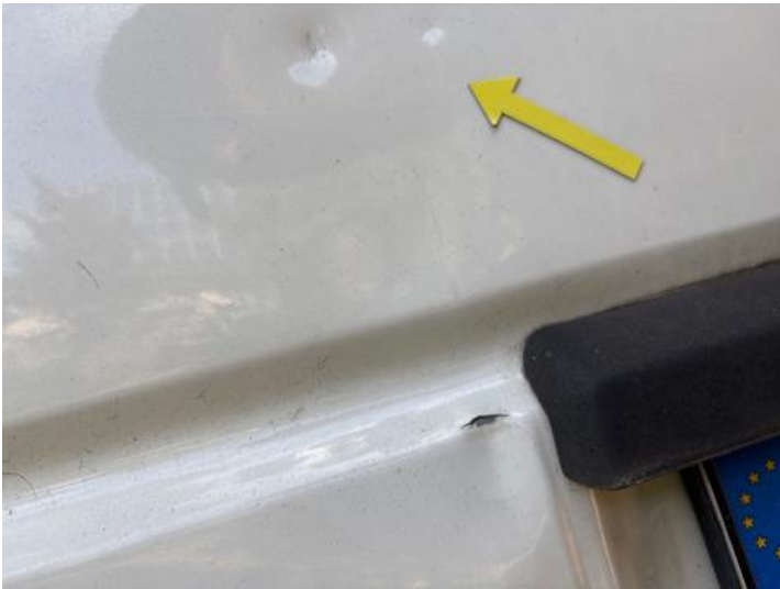
Heckklappe (Delle, Lackschaden)
