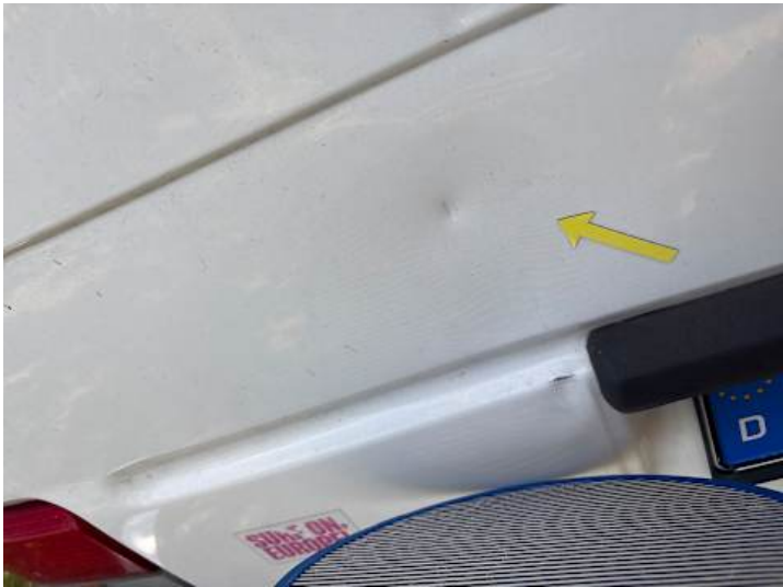
Heckklappe (Delle, Lackschaden)
