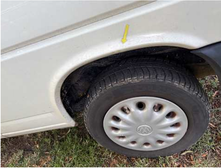
Seitenteil hinten links (Rost)
