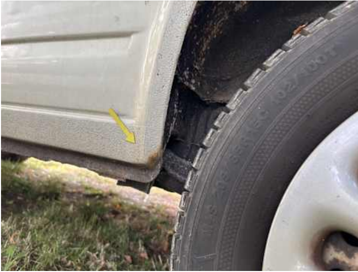
Schweller links (Rost)
