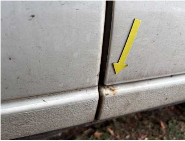
Schweller rechts (Rost)
