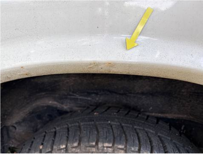
Seitenteil hinten links (Rost)
