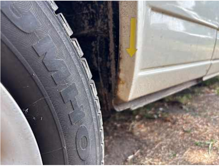
Seitenteil hinten rechts (Rost)
