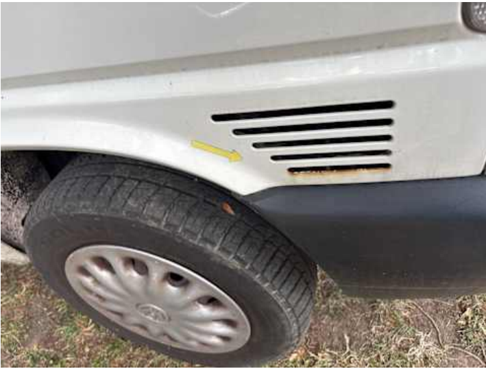
Kotflügel vorne rechts (Rost)
