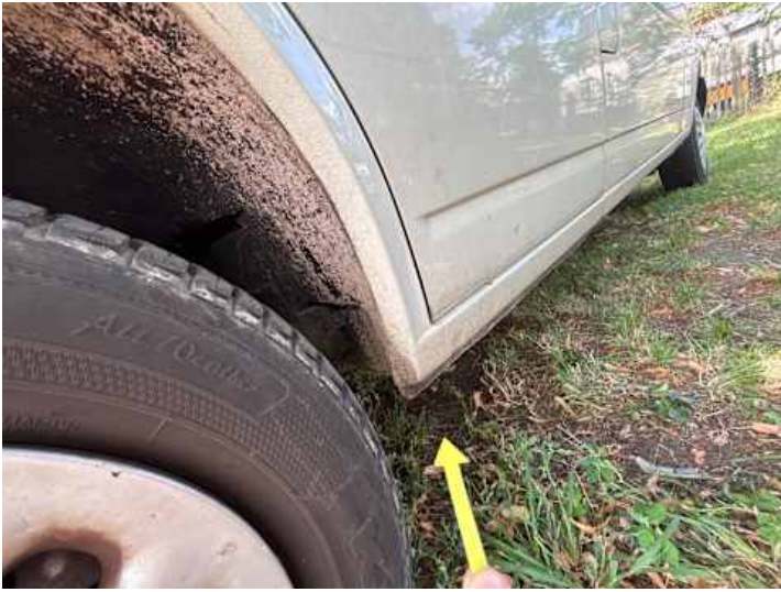
Schweller links (Rost)
