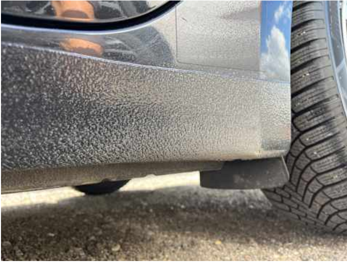
Schweller links (Steinschlag)
