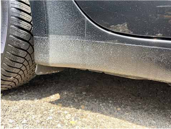
Schweller rechts (Steinschlag)
