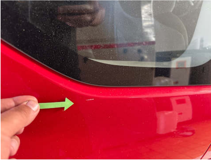
Seitenteil hinten rechts (Delle, Lackschaden)
