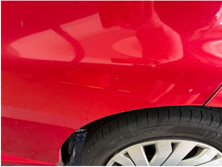
Seitenteil hinten links (Lackschaden, Kratzer)
