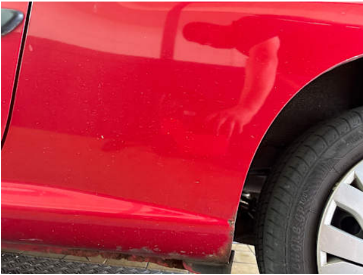
Seitenteil hinten links (Lackschaden, Rost)
