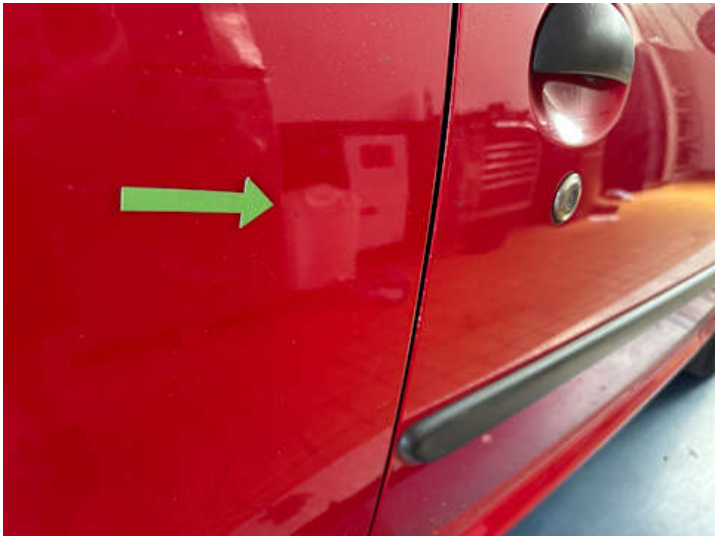
Seitenteil hinten rechts (Delle, Lackschaden)
