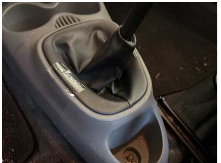
Innenraum (Verschleiß, Riss/Bruch)
