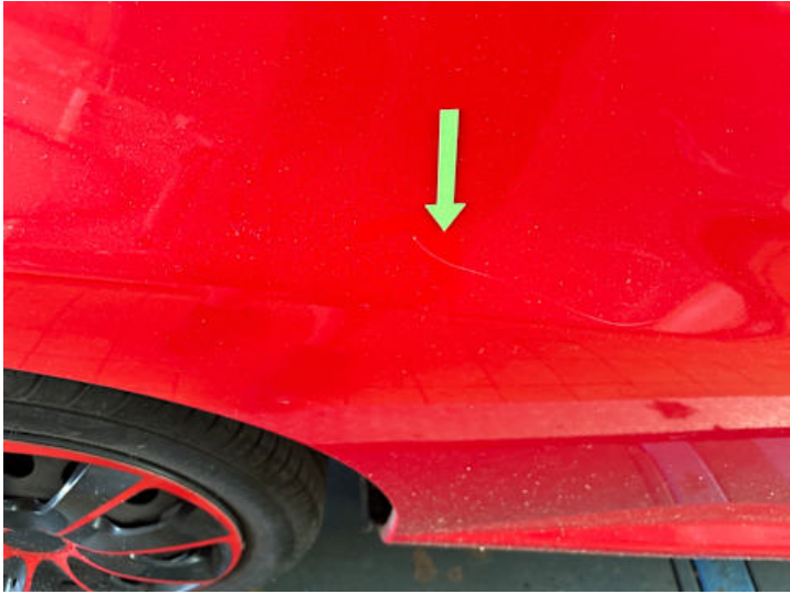
Seitenteil hinten rechts (Lackschaden, Kratzer)
