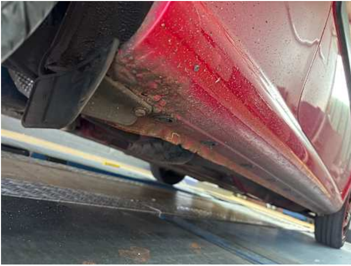
Schweller rechts (Lackschaden, Rost)
