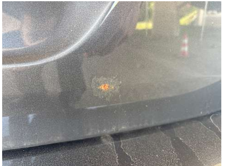
Heckklappe (Lackschaden, Rost, Unsachgemäß instand gesetzt)
