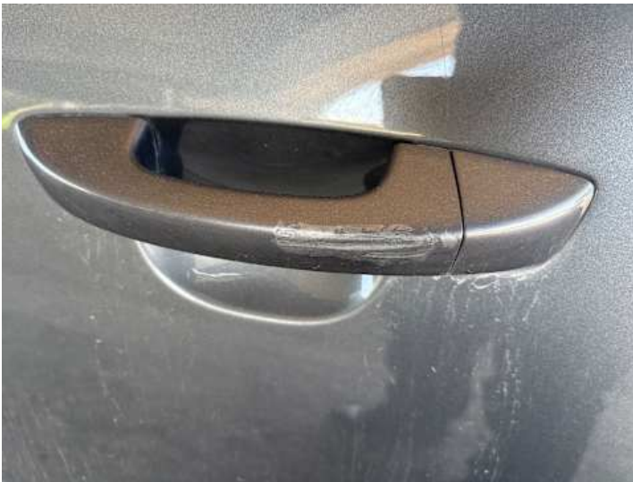
Türe hinten rechts (Lackschaden, Kratzer, Unsachgemäß instand gesetzt)
