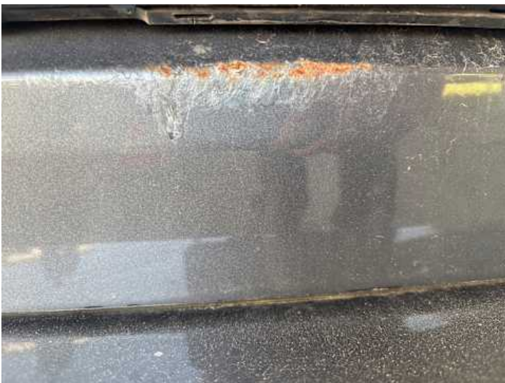
Heckklappe (Lackschaden, Rost, Unsachgemäß instand gesetzt)
